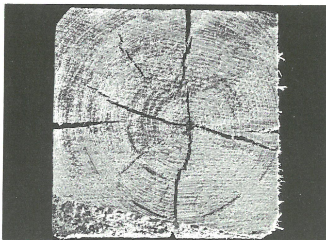
Abb. 25 : Probestütze V 20 D - Beispiel für die Schwindrißbildung bei Vollholz-Stützen
