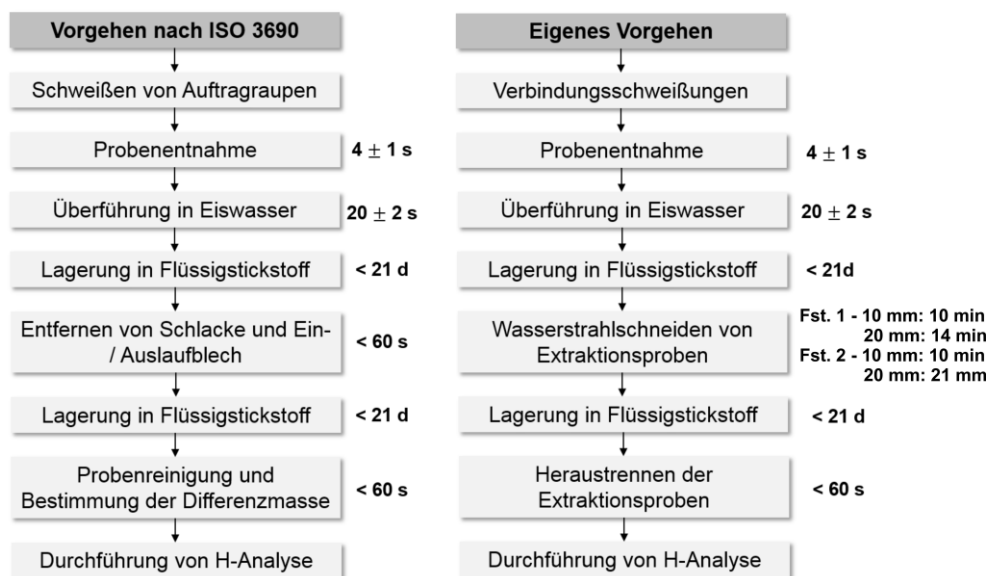
Abbildung 6.13: Gegenüberstellung des Vorgehens der Wasserstoffbestimmung nach ISO 3690 und dem eigenen Vorgehen
