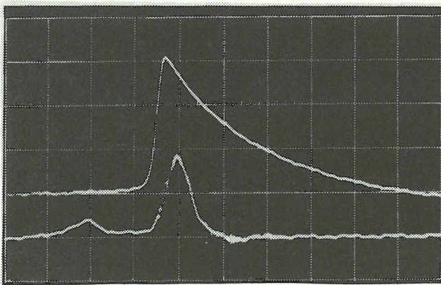
Bild 42 Zeitlicher Druckverlauf bei einer Explosion mit Druckentlastung Versuchsanordnung s. Bild 40 und Tabelle 11 oberer Strahl: Verlauf in V_2 unterer Strahl: Verlauf in V_1 Ordinate: 2,5 bar/cm Ordinate: 1 bar/cm Abszisse: 20 ms/cm Abszisse: 20 ms/cm
