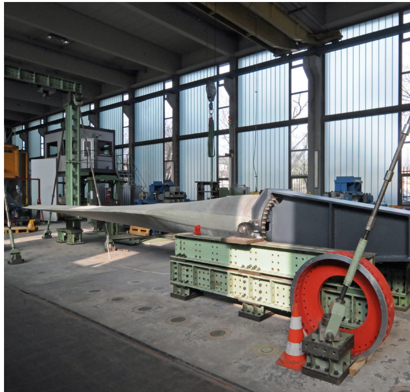
Abbildung 3: Teil eines Rotorblattes einer Windenergieanlage im Prüfstand zur Untersuchung des Betriebsfestigkeits- und Schädigungsverhaltens unter Schlag- und Schwenklast.
