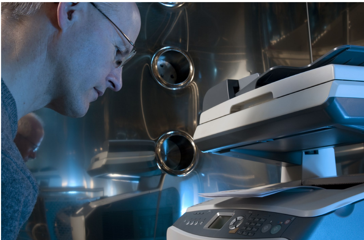
Abbildung 9: Entwicklung eines validierten Verfahrens zur Bestimmung von Nanopartikel-Emissionen aus Druckern und Kopierern in der Luft.
