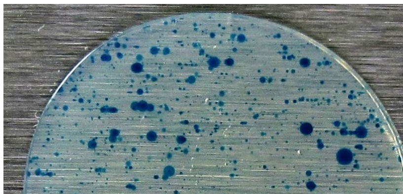
Abbildung 16: Korropad: Schnelltest für Oberflächen nichtrostender Stähle.
