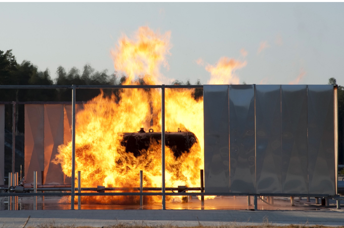
Abbildung 8: Brandversuch mit einem zu 20% mit Ethanol befülltem 2700 Liter Tank mit Sicherheitsventil im Feuer auf dem Brandprüfstand in Horstwalde auf dem BAM TTS.
