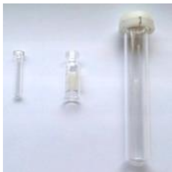
Abbildung 8.14: Reaktionsgefäße für die Mikrowelle mit unterschiedlichen Volumina (von links nach rechts): 300 \mu L, 1,5 mL und 10 mL (links), Mikrowelleneinsatz der Firma CEM für 1,5 mL-HPLC-Gläschen (rechts).
