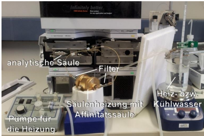
Abbildung 10.17: Aufbau der HPLC-Anlage für die thermische Online-Methode.
