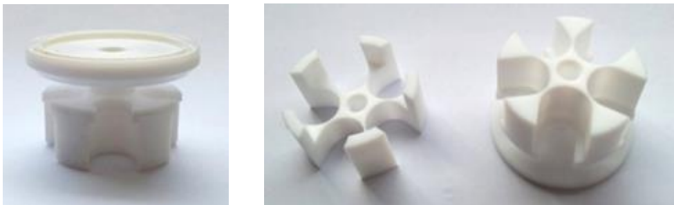
Abbildung 8.16: Modifizierte HPLC-Gläschen-Halter für die Hydrolyse-Reaktionskammer der Mikrowelle. Der einteilige Reaktionshalter wird oben eingehängt (links), der zweiteilige wird auf die Füßchenkonstruktion – mit Aussparung für den Magnetrührstab – gestellt (rechts).
