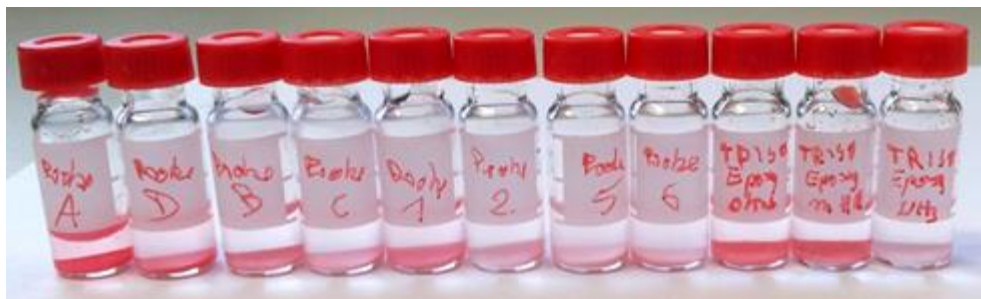
Abbildung 8.10: Verschiedene mit Dabsyl-BSA gekoppelte Trisopor™-Proben, im saurem Milieu, Proben analog Abb. 8.9.
