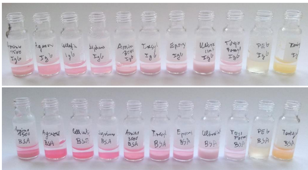
Abbildung 8.18: Mit Dabsyl-IgG (oben) bzw. Dabsyl-BSA (unten) gekoppelte Trägermaterialien nach Zugabe von 6 M HCl (von links nach rechts: Trisopor™ 1500, Agarose, Cellufine™, Sepharose™, Trisopor™ 3000, Toyopearl®-Tresyl, Fractogel® EMD-Epoxy, UltraLink™, Toyopearl®-Formyl, ChemMatrix® (PEG), TentaGel®).
