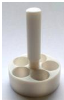
Abbildung 8.14: Reaktionsgefäße für die Mikrowelle mit unterschiedlichen Volumina (von links nach rechts): 300 \mu L, 1,5 mL und 10 mL (links), Mikrowelleneinsatz der Firma CEM für 1,5 mL-HPLC-Gläschen (rechts).
