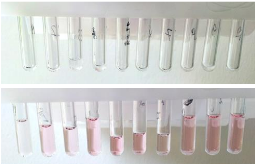
Abbildung 8.13: Wasser (oben) und Dabsyl-BSA (unten) nach Erhitzung in 300 \mu L-Gasphasenhydrolyse-Reaktionsgefäßen (Mikrowellenmethode: 150 W, 130°C, 10 min hold).
