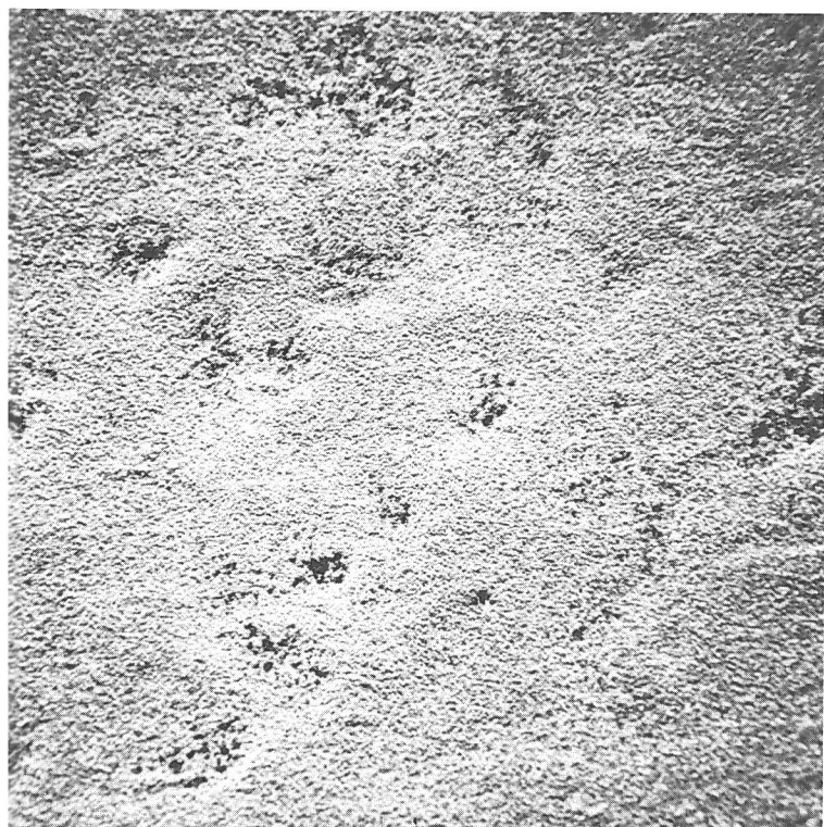
Bild 19 REM-Aufnahme einer Mattnickel-Oberfläche (Dicke 10 \mu\text{m} ); Vergrößerung 200 : 1
