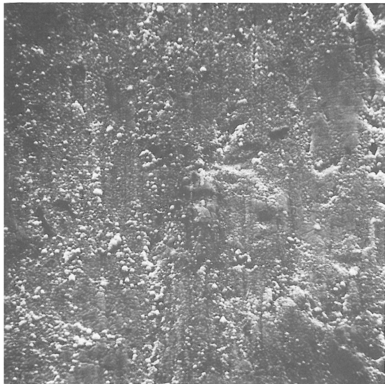
Bild 25 REM-Aufnahme einer Nickel-Aufdampfschicht (Dicke 10\ \mu\text{m} ); Vergrößerung 2000 : 1
