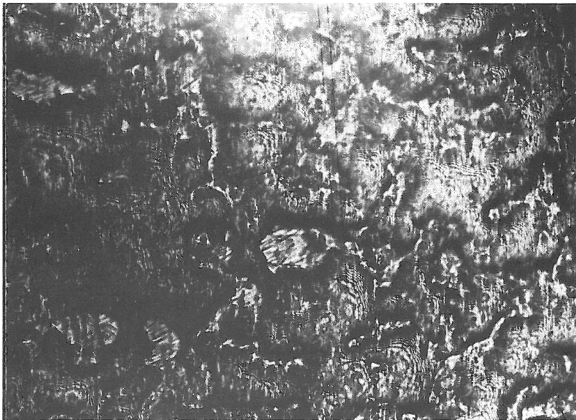
Bild 8 Interferenzbild der Grund- metalloberfläche in Licht der Wellenlänge \lambda = 0,548 \mu\text{m}
