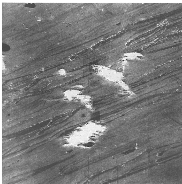
Bild 39 REM-Aufnahme einer Zinn-Aufdampfschicht (Dicke 5 \mu\text{m} ); Vergrößerung 200 : 1
