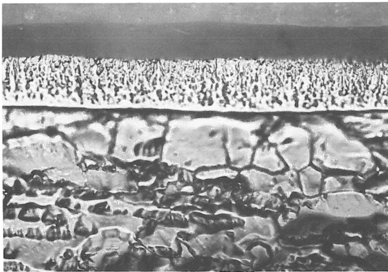
Bild 51 Querschliff einer Aufdampf-Nickelschicht auf Stahl; Vergrößerung 1000 : 1
