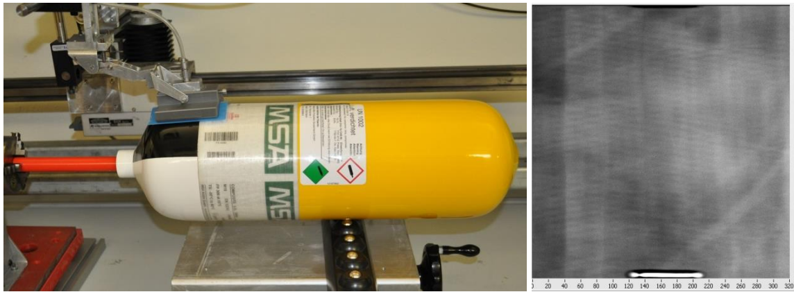
Abb. 1. Prüfaufbau und bildhafte Darstellung des Prüfergebnisses an einem Composite-Druckgefäß.
