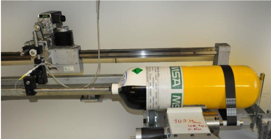
Abb. 5: Vorrichtung für die Innenprüfung von Druckgefäßen mit dem Wirbelstromverfahren.
