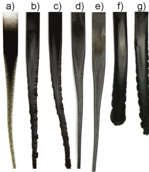
Abb. 3.6: Rückstände aus dem vertikalen UL 94 Testaufbau: a) PP, b) PP/5CB, c) PP/5CNT, d) PP/5EG40, e) PP/5EG60, f) PP/5MLG, g) PP/5G
