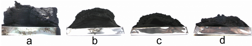
Abb. 5.7: Einfluss steigender G Konzentration auf die Entwicklung der intumeszenten Schicht während des Brandes: a) ohne G, b) 0,5 Gew.% G, c) 1 Gew.% G, d) 2 Gew.% G
