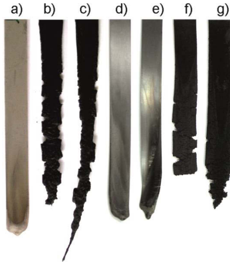
Abb. 3.16: Rückstände aus dem vertikalen UL 94 Testaufbau: a) PP-FR, b) PP-FR/5CB c) PP-FR/5CNT, d) PP-FR/5EG40, e) PP-FR/5EG60, f) PP-FR/5MLG, g) PP-FR/5G
