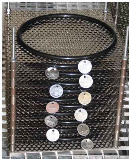
Bild 4.2 Lochblechregal mit EPDM-O-Ringen, versehen mit Werkzeugmarken
