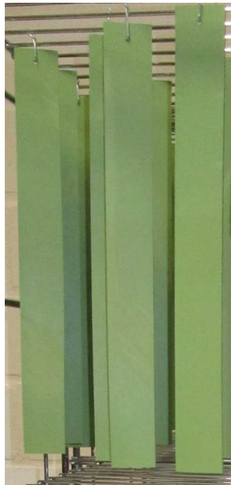
Bild 4.7 dünne Gummistreifen, zur Alterung an Gestelle gehängt
