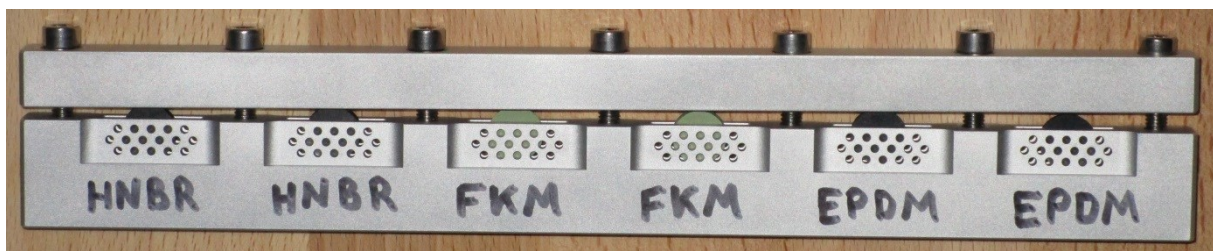
Bild 4.8 Konstruktion zur Alterung von verpressten dünnen Proben mit Luftzufuhr (vor der Verpressung)
