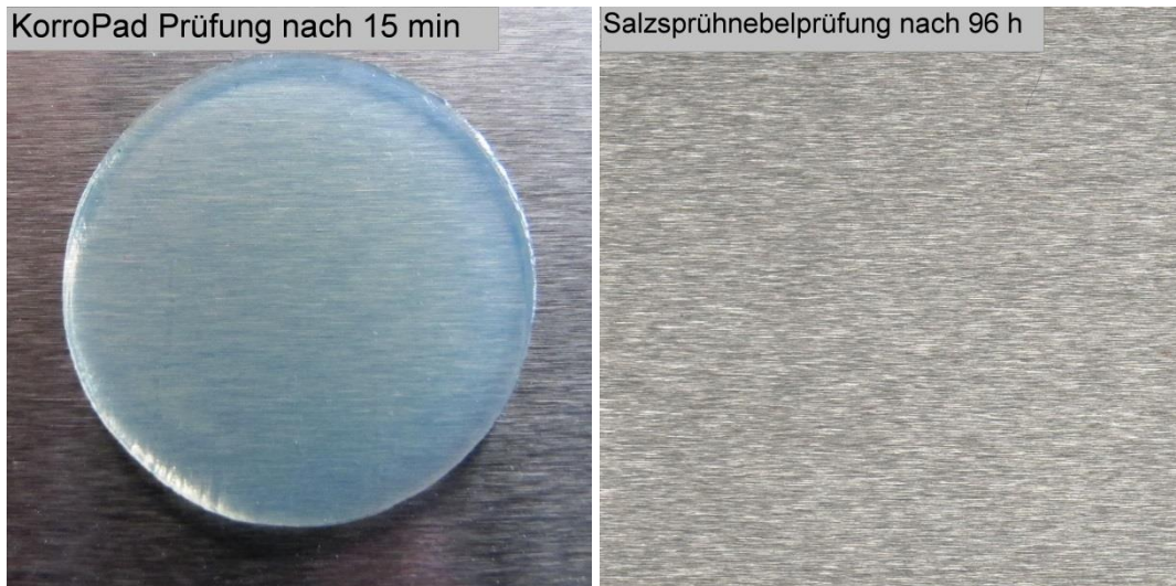
Abb. 5. Prüfergebnisse an einer geschliffen korrosionsbeständigen Probe Wst 1.4301
