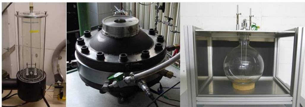
Abb. 12: Versuchsaapparaturen zur Bestimmung der Explosionsgrenzen, v.l.n.r.: Methode T nach EN 1839, Methode B nach EN 1839, Rundkolben nach ASTM E681
