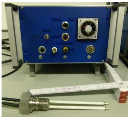
Abb. 26: Hochspannungstransformator mit Funkenzünder
