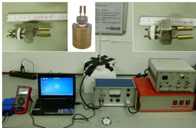
Abb. 32: Versuchsaufbau kalorimetrische Messungen: o. li.: Gleitfunkenzündgerät, o. m.: Bombenkalorimeter, o. re.: Drahtzündgerät, u.: Gesamtaufbau mit Zündgeräten und Messtechnik
