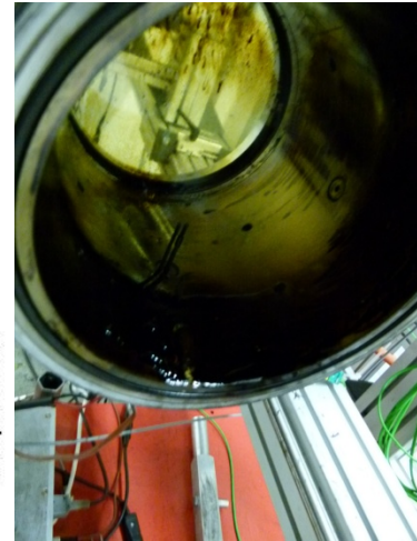
Abb. 48: Reaktionsrückstände nach Versuch Abb. 47
