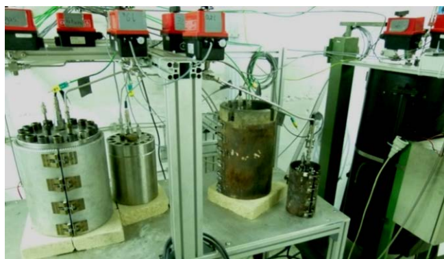
Abb. 17: Apparatur für vergleichende Zündversuche bei hohen Anfangsdrücken, v. l. n. r.: Zündautoklav V = 6 \text{ dm}^3 , V = 1 \text{ dm}^3 , V = 3 \text{ dm}^3 , V = 0,2 \text{ dm}^3 und Mischautoklav ( V = 20 \text{ dm}^3 , rechter Bildrand)
