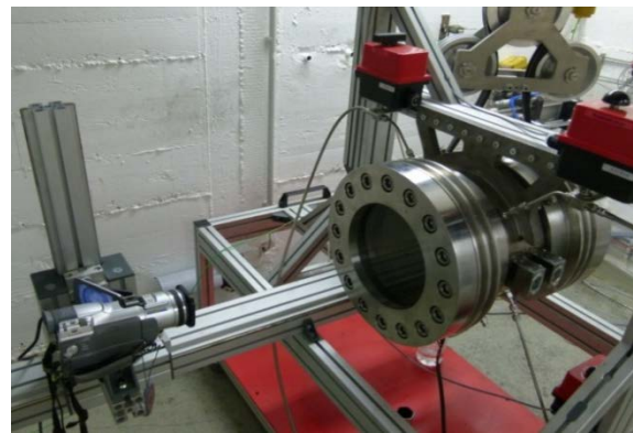
Abb. 20: Montierter Fensterautoklav am Gestell, links Videokamera an Halteschiene
