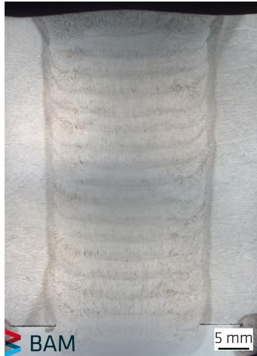
**Abbildung:** Schliff S2 (Spaltbreite 24 mm)
