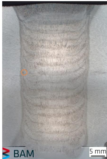
**Abbildung:** Schliff S4 (Spaltbreite 18 mm)
