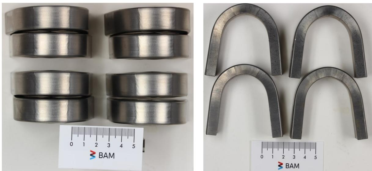
**Abbildung links:** Querbiegeproben Demonstratorschweißung (links B5 – B8, rechts B1 – B4)
