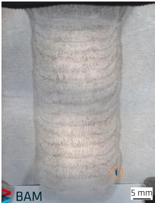
**Abbildung:** Schliff S3 (Spaltbreite 19 mm)
