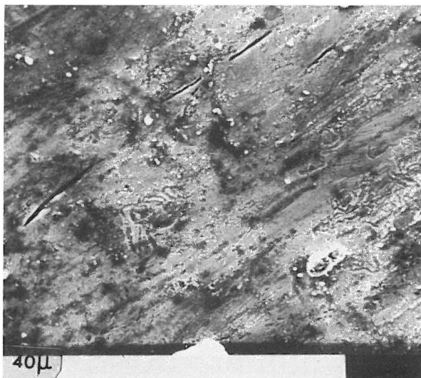
Bild 79 V = 500 : 1 Risse und Poren auf gestreckten Korngrenzen bei Cu Zn 37
