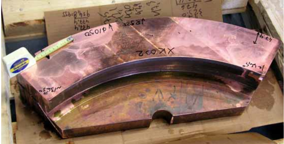
Abbildung 4.5: Referenzprüfkörper für die RT-Prüfung mit Nuten und Bohrungen (Quelle: [178])
