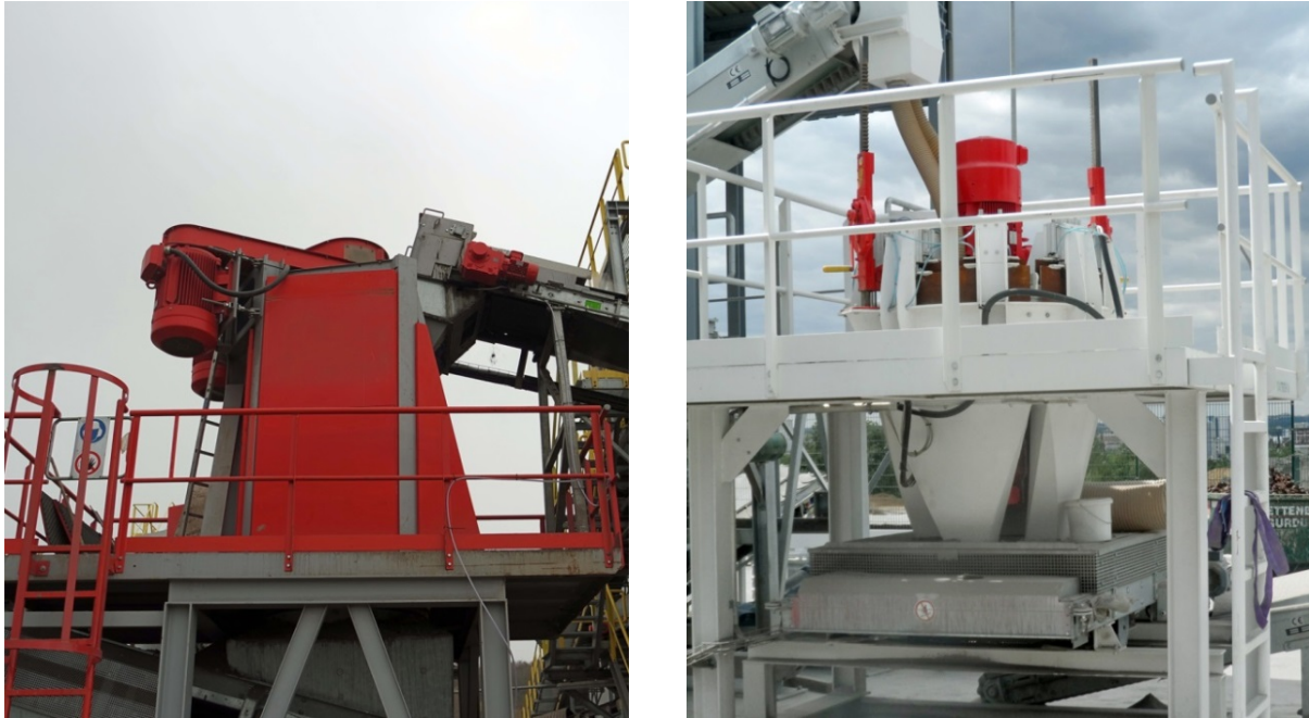
Abb. 2: Im Rahmen des Projektes (weiter-)entwickelte TAR-Prozessoren (Hochgeschwindigkeits-Rotations-Beschleuniger) zum Prallaufschluss von HMVA: Alpha-Linie (links) und Beta-Linie (rechts).
