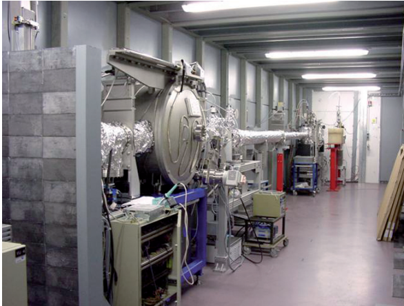
Abb. 5 Messaufbau der synchrotronbasierten Röntgenfluoreszenzanalyse (Sy-RFA).
