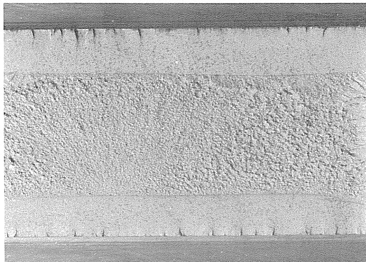
Bild 64 Bruchfläche Probe Form 2 b, Versuch Nr. 6 Prüftemperatur -105^{\circ}\text{C}/168\text{ K} St E 47 Bruchlast F_{\max} = 1495\text{ kN}
