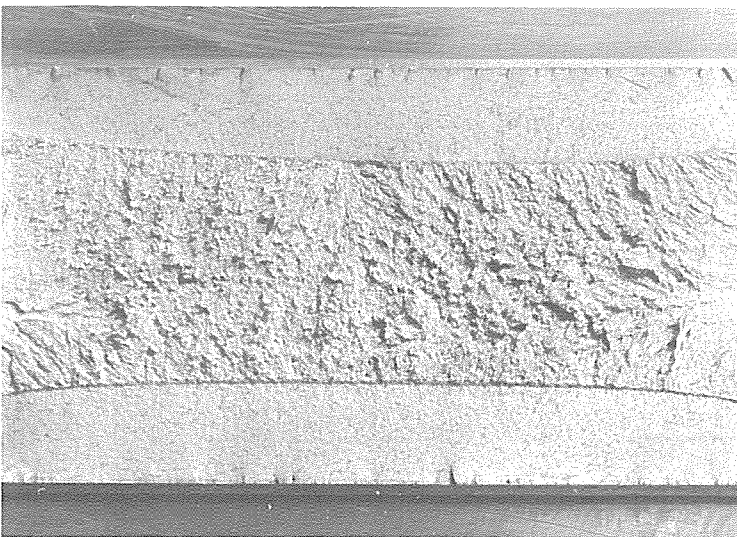
Bild 68 Bruchfläche Probe Form 1 b, Versuch Nr. 27 Prüftemperatur -50^{\circ}\text{C}/223\text{ K} St E 47 Bruchlast F_{\max} = 1720\text{ kN}
