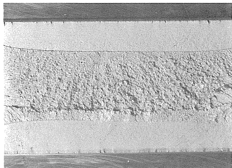
Bild 65 Bruchfläche Probe Form 2 b Versuch Nr. 12 Prüftemperatur -73^{\circ}\text{C}/200\text{ K} St E 47 Bruchlast F_{\max} = 1680\text{ kN}
