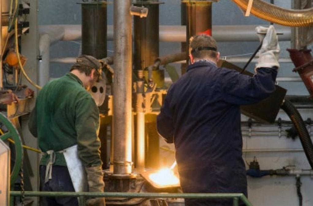
*Entnahme einer Löffelprobe aus einer Mineralschmelze zur Kalibrierung des elektrischen Lichtbogenofens*
