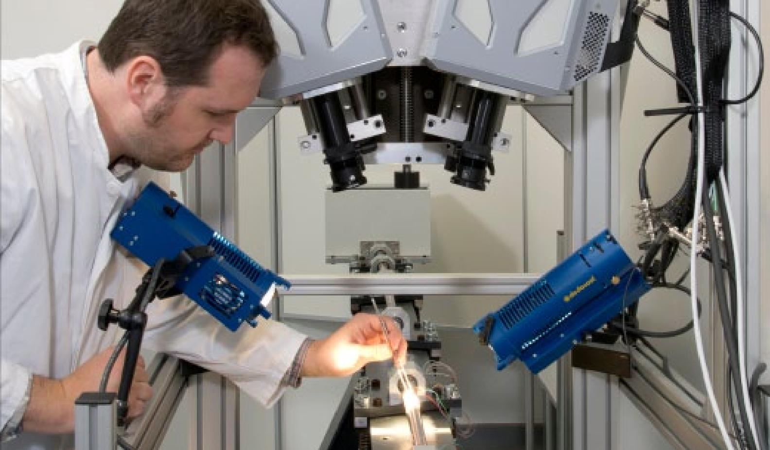
*Vorbereitung eines Experimentes zur Charakterisierung hochdynamischer Materialeigenschaften von Proben aus Metallen und Metallschäumen*
