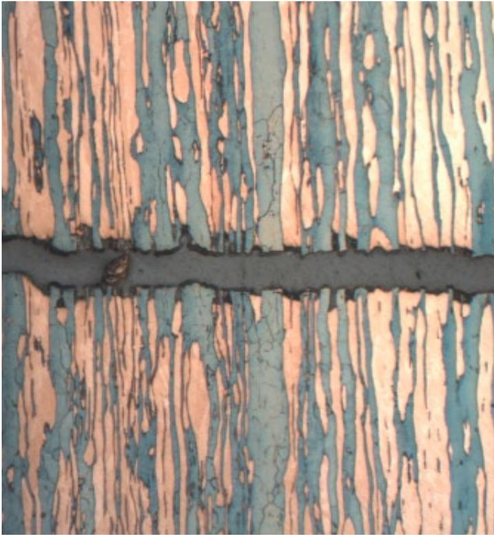
*Primäre Korrosion der austenitischen Phase (hell) entlang der Rissflanken, Probe im Längsschliff*
