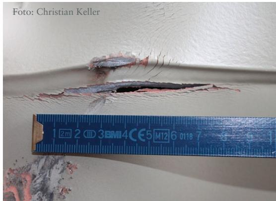
*Große plastische Deformationen im Bereich des Aufpralls auf eine Containerecke mit aufgerissenen Seitenwandblech*
