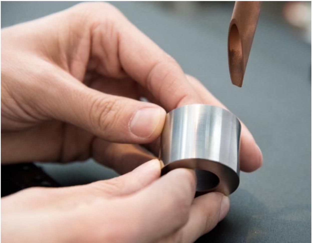
*Miniaturre roller mit laserimplantierter Oberfläche*
