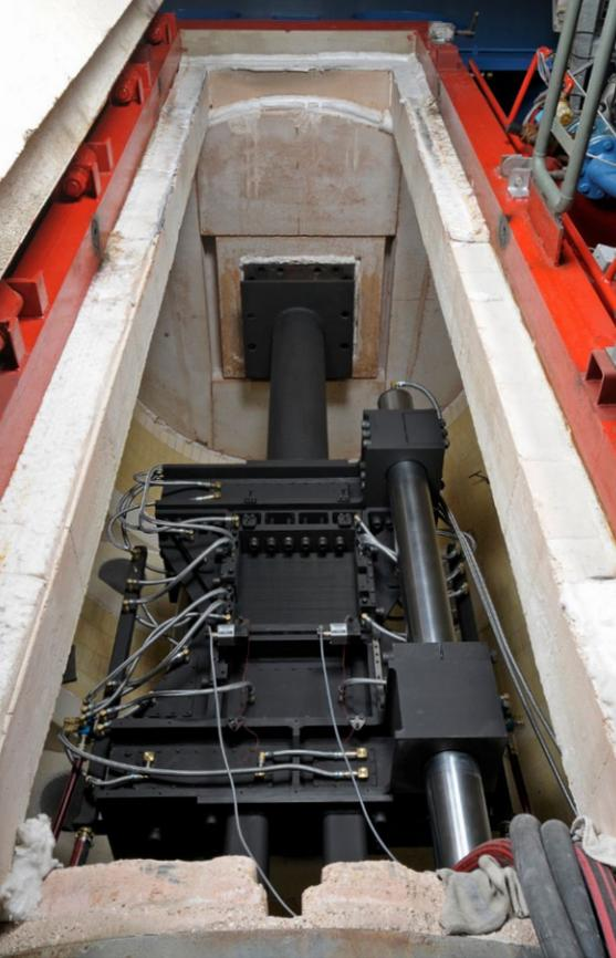
*Sandwich-Palette aus Carbonfaser verstärktem Kunststoffverbund vor dem Brandversuch im Intermediate-Versuchsstand*
