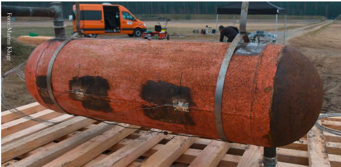
*Prüfkörper zur Bestimmung des effektiven Wärmeeintrags durch Unterfeuerung*
