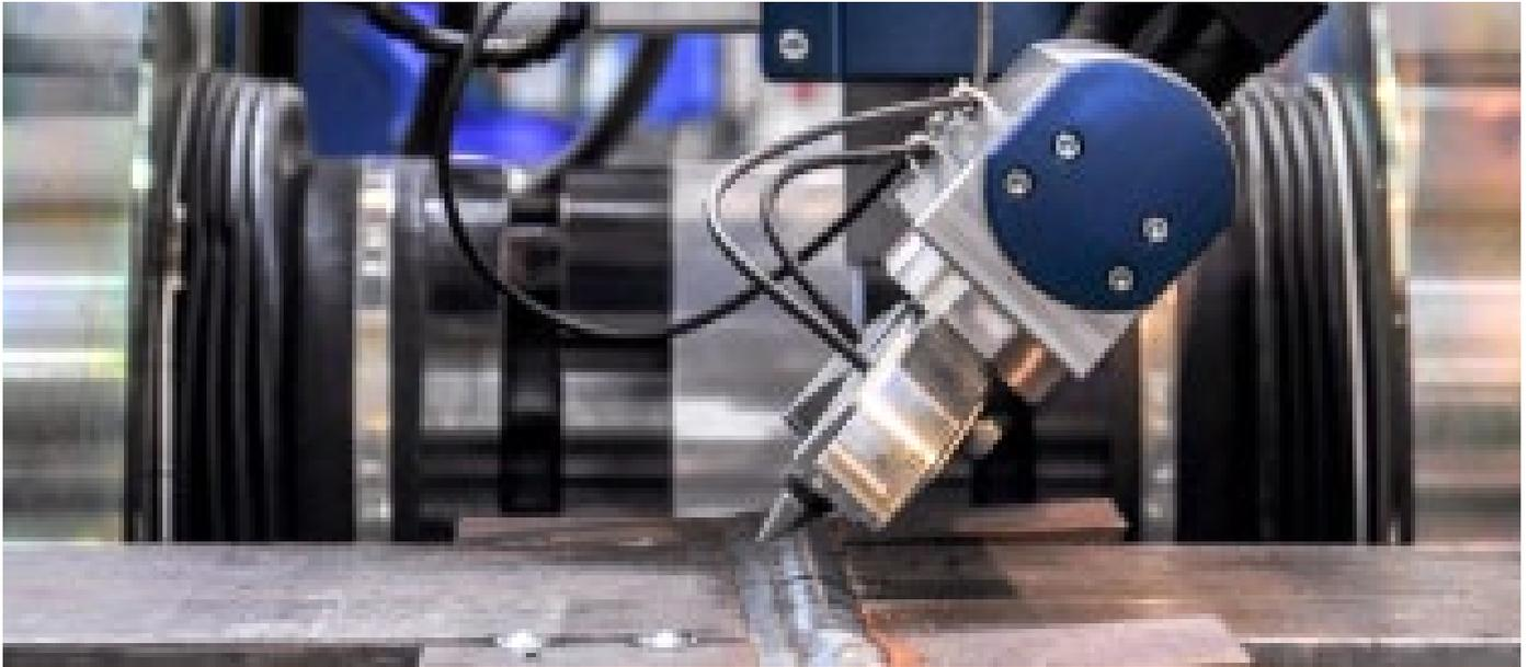
*Messung der Eigenspannung im geschweißten Bauteil mittels Röntgenstrahlung in der 2-MN-Prüfanlage
