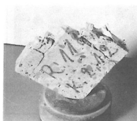
Bild 10.3 25 mm dicke Betonplatte nach Prüfung mit schlaffen Druckplatten
