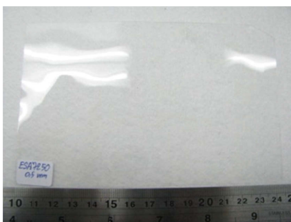
a) ESA 7250 silicone sheet specimen
