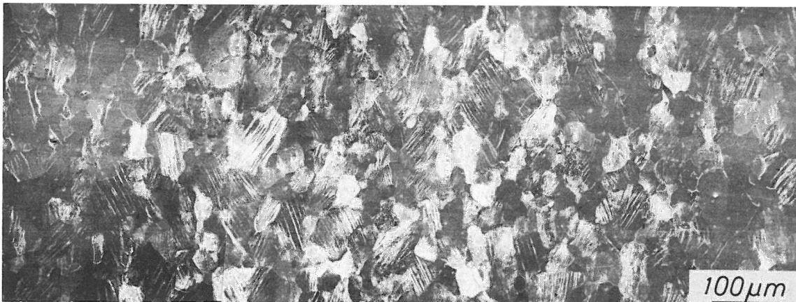
Abb. 6.15 Oberfläche einer St 37-Wechselbiegeprobe im Stadium des Rißwachstums an der gekerbten Unterseite (Probe Nr. 5, \hat{\epsilon}_{ges,R} \approx 7 \cdot 10^{-4} , N = 185\ 000 )
