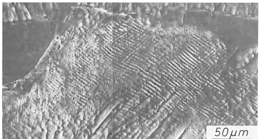
Abb. 5.23 Gemeinsames Auftreten von Netzstrukturen und Feingleitung in einem Korn (Al 99,999; Nr. 545; \hat{\epsilon}_{\text{ges,R}} = 2,8 \cdot 10^{-4} ; N = 580 000)
