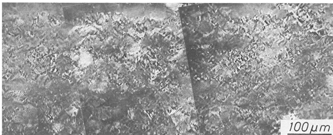
Abb. 5.21 Netzstrukturen nach Wechselbiege-Zerrüttung an der Oberfläche einer feinkörnigen Al 99,9-Probe
