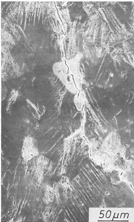
Abb. 6.19 Zerrüttungsriß an der ebenen elektrolytisch polierten Oberseite einer St 37-Wechselbiegeprobe, gleiche Probe wie in Abb. 6.15
