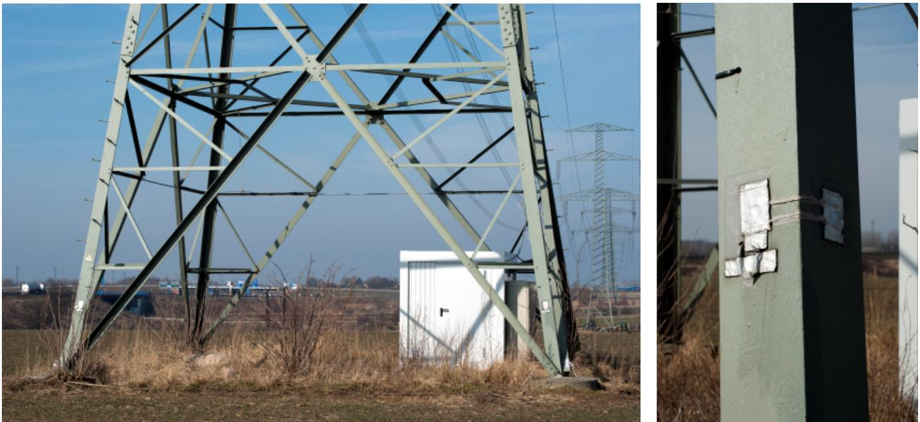
**Abbildung B.4:** Mastfuß des Tragmasts T17 mit Container für Messrechner (links) und an den Eckstielen verklebten Dehnmessstreifen (rechts)
