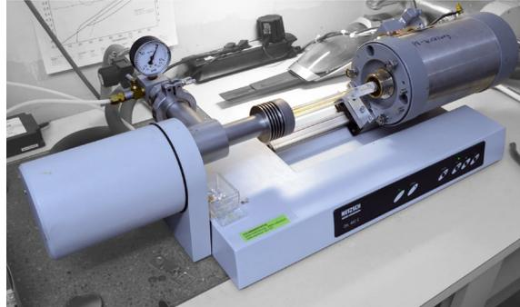
**Abb. 4.33:** Untersuchung des Wärmeausdehnungskoeffizienten mit Hilfe eines Dilatometers
