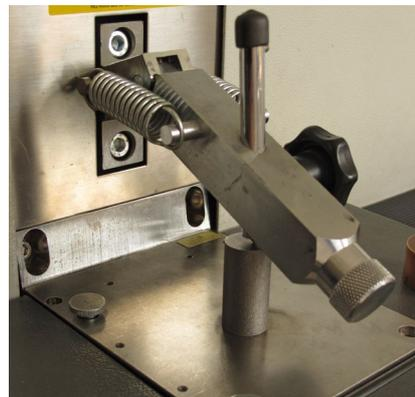
**Abb. 4.04:** Untersuchte Rundprobe am Funken-Emissions-Spektrometer (FES)
