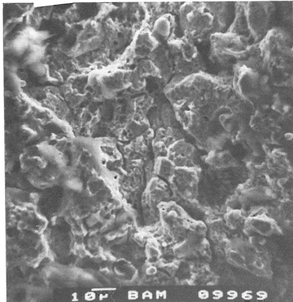
Bild 18: Mikrofraktographisches Bruchaussehen einer angerosteten und für die Unter- suchung abgebeizten Bruchfläche aus Spannglied XII 1, Bruch verläuft in- terkristallin, Korngrenzen durch Kor- rosion aufgelöst, Korngrenzflächen sind stark angegriffen
