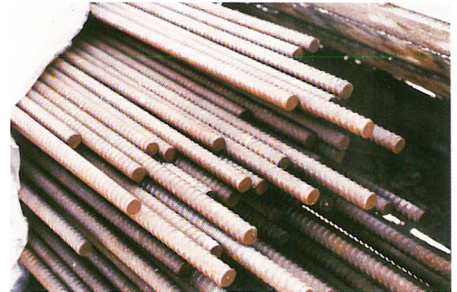
Abb. 24 Rost auf gelagerten Spannstählen
