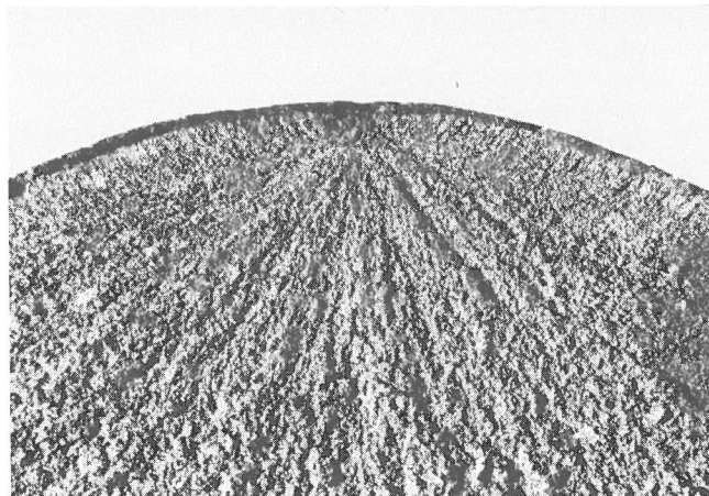
Abb. 93 Bruchausgang Versuch 12, Stahl B (Vergrößerung 12 : 1)
