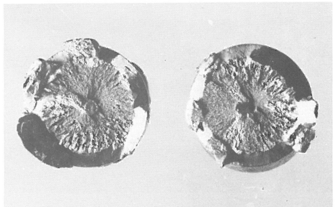
Abb. 99 Spröder Bruch, Stahl E, Versuch 69 (Vergrößerung 3 : 1)
