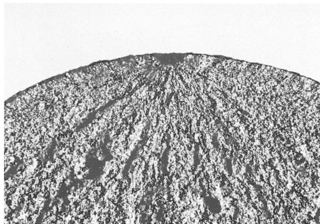
Abb. 94 Bruchausgang Versuch 13, Stahl B (Vergrößerung 12 : 1)
