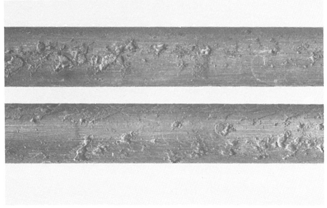
Abb. 106 Narbenkorrosion in der Umgebung des Bruches, Stahl E, Versuch 66 (Vergrößerung 2 : 1)
