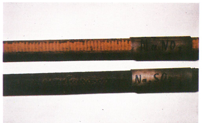
Abb. 65 Vorkorrosion in \text{NO}_3^- - bzw. \text{SO}_4^{2-} -haltiger Umgebung (500 mg/l), Stahl B
