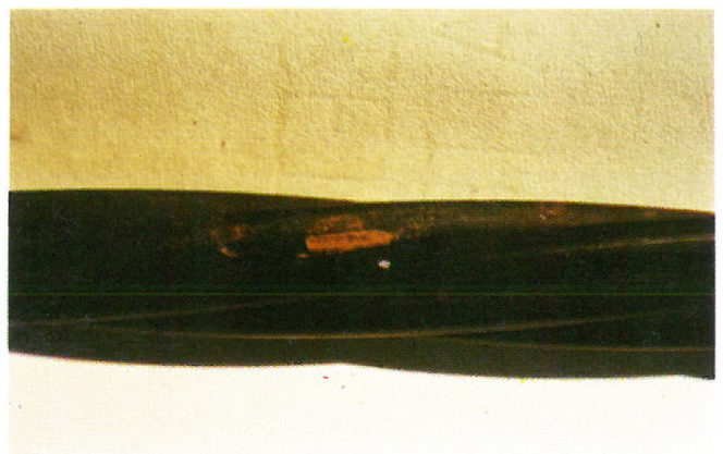
Abb. 19 Korrosion im Zwickelbereich von Litzen
