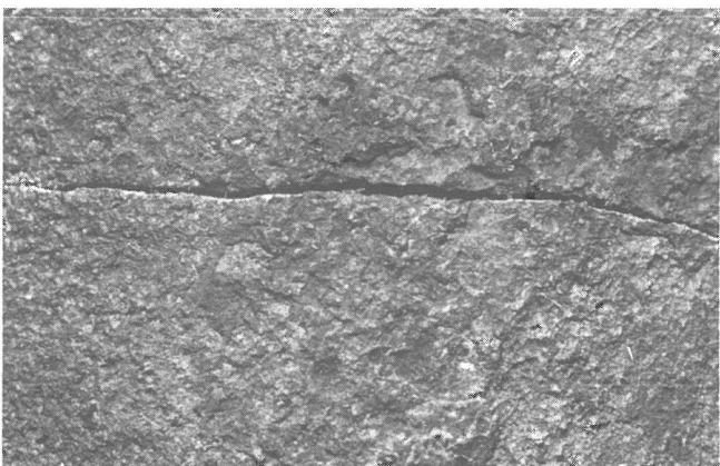
Abb. 111 Querriß neben der Bruchfläche, Stahl D 2, Versuch 67 (Vergrößerung 13 : 1)
