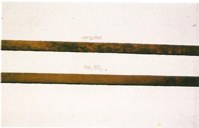
Abb. 66 Vorkorrosion in \text{SO}_3^{--} -haltiger Umgebung (300 mg/l), Stahl D 2
