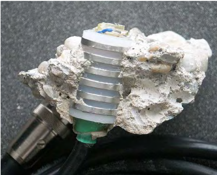
Bild 4.3-1: ausgebaute MRE (Fa. Sensortec)
