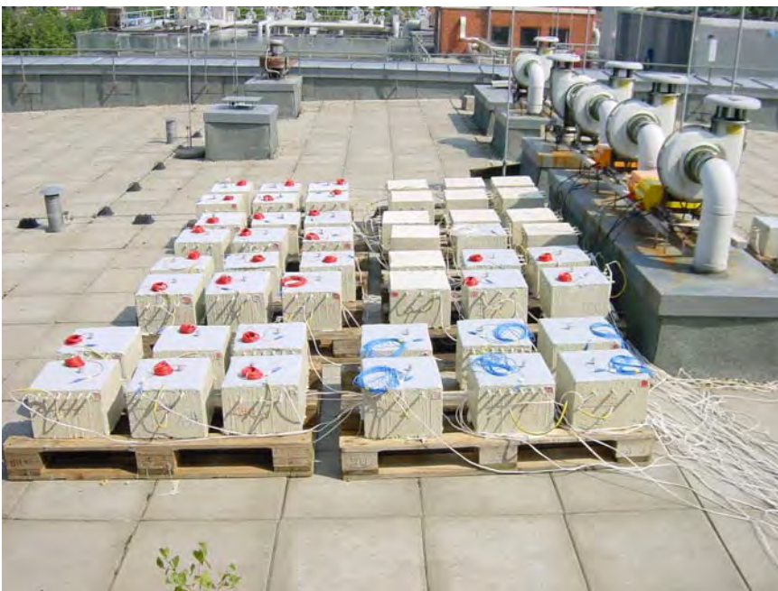
Bild 4.3-5: Auslagerung der Probekörper auf einer Dachfläche, BAM, Berlin
