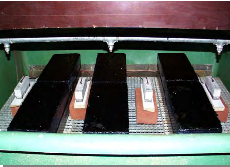
Bild 4.2-4: Anlage zur Simulation des Gewitterregens sowie der Wärmebeanspruchung
