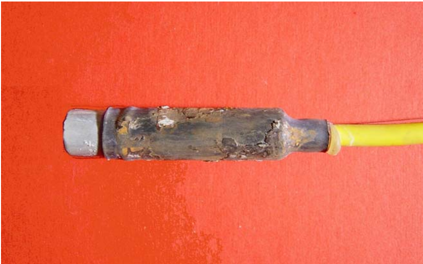
Bild 4.3-2: ausgebaute MnO 2 -Elektrode (Fa. Force, DK)
