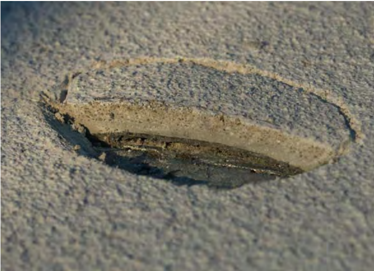
Bild 4.3-18: geöffnete Fehlstelle Probe 216
