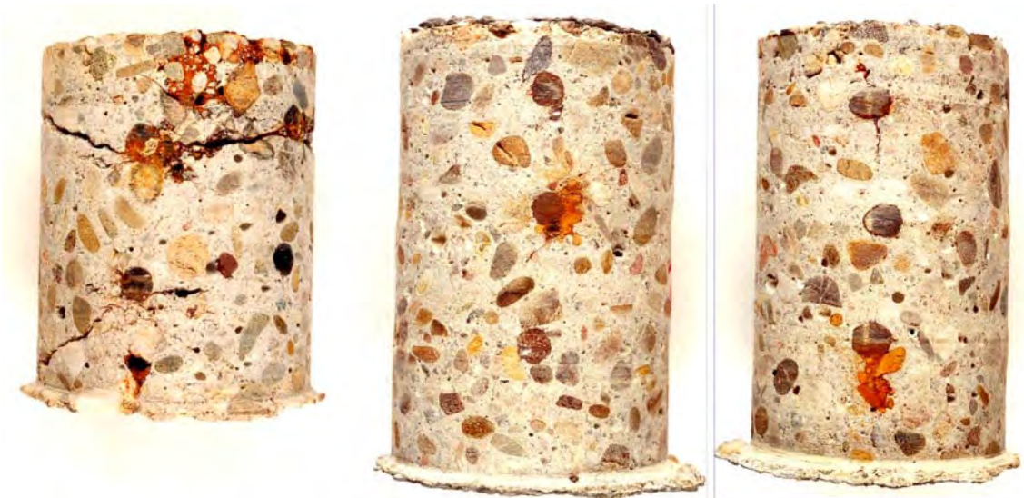
Bild 4.4-11: Aus den Probekörpern entnommene Bohrkern (Links: Platte 1, Mitte: Platte 2, Rechts: Platte 3)
