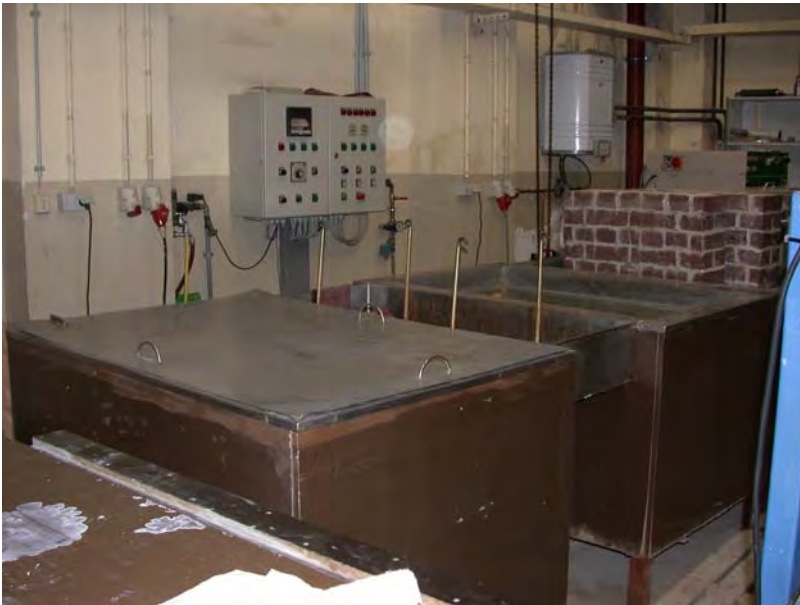
Bild 4.2-5: Zweibeckenanlage zur Durchführung der Temperaturwechselbeanspruchung
