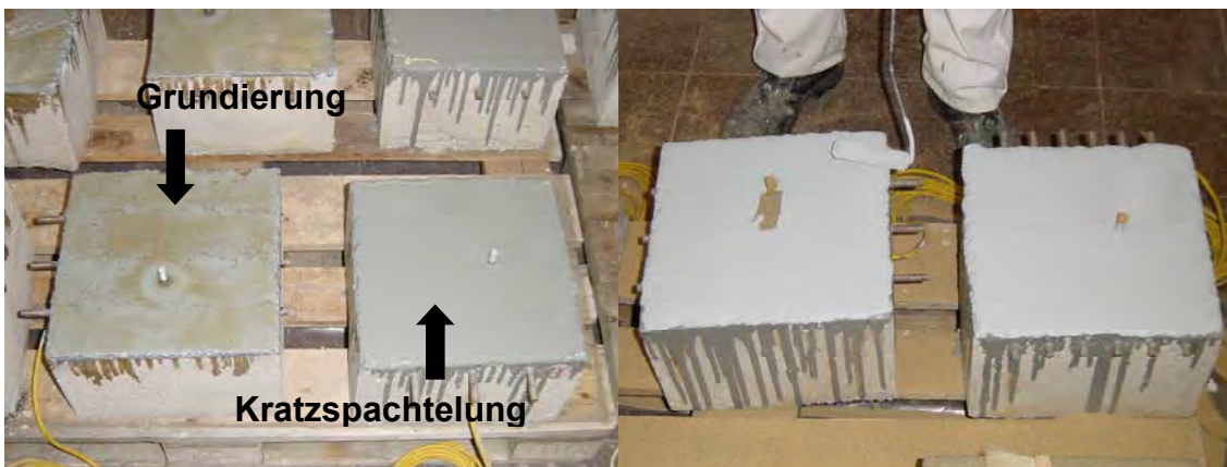
Bild 4.3-4: Aufbringung des Oberflächenschutzsystems; links: Grundierung und Kratzspachtelung, rechts: Deckversiegelung
