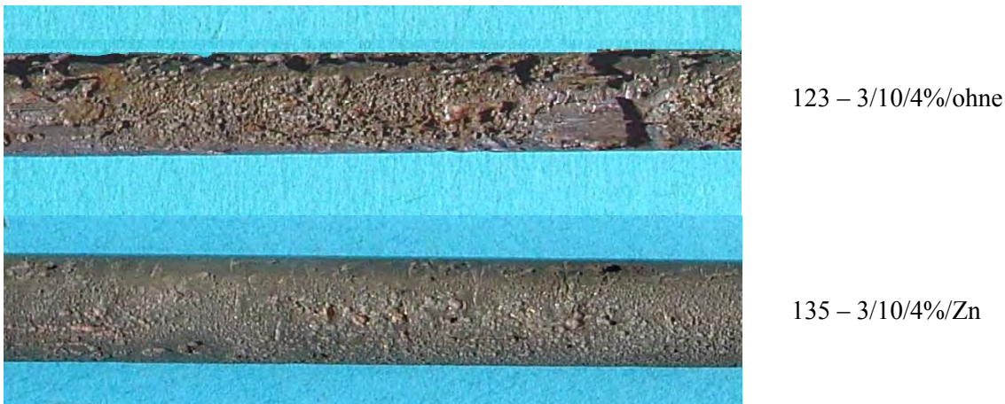
Bild 4.3-23: Erscheinungsbild der ausgebauten Bewehrung nach dem Beizen
