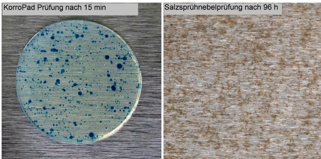
**Abb. 6.** Prüfergebnisse an einer geschliffenen korrosionsanfälligen Probe Wst 1.4301
