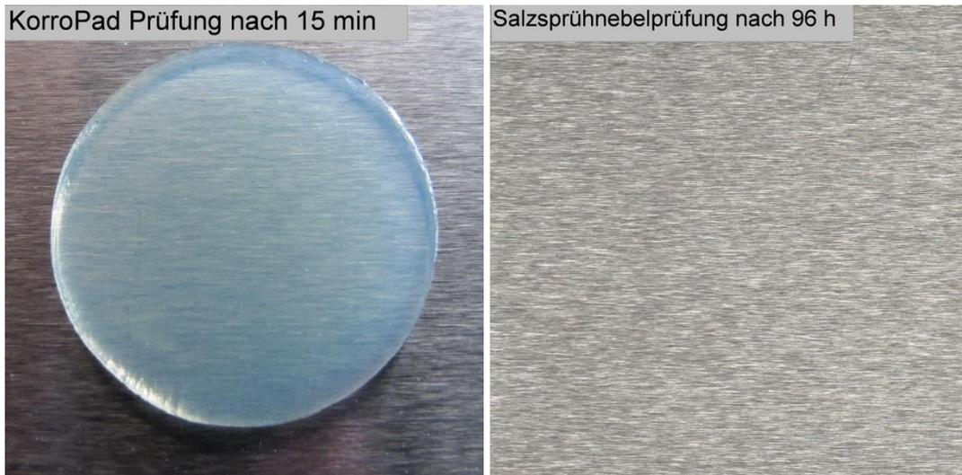
**Abb. 5.** Prüfergebnisse an einer geschliffen korrosionsbeständigen Probe Wst 1.4301
