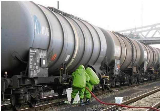
Abb. 17: Güterbahnhof Peine, 26.7.2009 Freisetzung von Octen aus undichtem Ventil [29]
