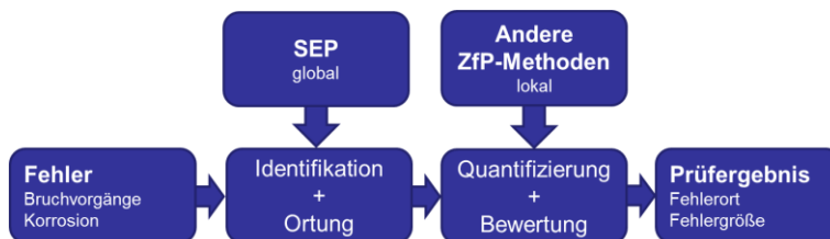
Abb. 1-3: Aufgaben der Schallemissionsprüfung (SEP) bei einer zerstörungsfreien Prüfung
