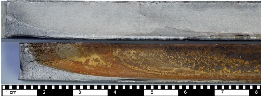
Abb. 4-1: Bruchflächen der Platte 5, Randbereich; Oben: ohne und unten: mit Korrosionseinfluss
