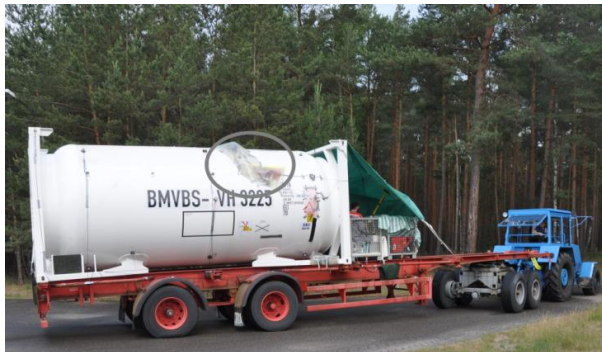
Abb. D-73: Fahrtst auf einer Asphaltstraße; die am Tank installierte Sandquelle ist zum Schutz vor Regen mit einer Plastikfolie bedeckt
