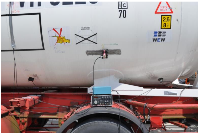
Abb. D-62: Aufbau des Pulsgenerators, eines Funktionsgenerators zur Triggerung der Puls-Rate und den Ultraschallpulsler am Tank
