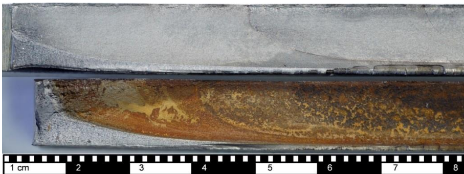
Abb. D-10: Bruchflächen der Platte 5, Randbereich; Oben: ohne und unten: mit Korrosionseinfluss
