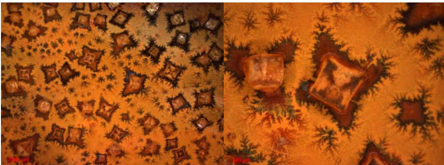
Abb. 4-3: Mikroskopische Aufnahme einer korrodierten Fläche
