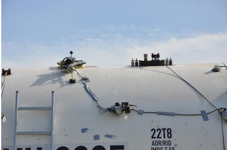
Abb. D-66: Künstliche SE-Quellen am Tank: Sandquelle SQ (links) mit Funkverbindung (mitte) und Korrosionsquelle KQ2 (rechts)
