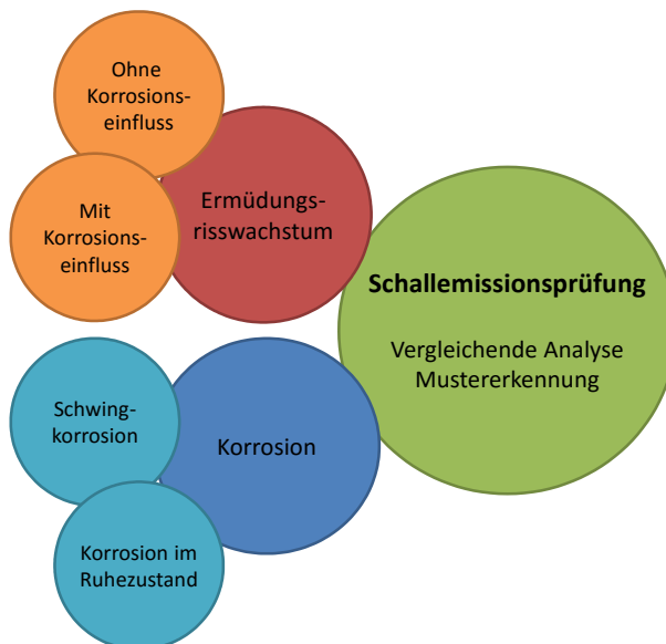
Abb. 1-6: Wissenschaftlicher Beitrag: Vergleichende Analyse und Klassifikation der Schadensmechanismen Korrosion im Ruhezustand, Schwingkorrosion sowie Ermüdungsrisswachstum mit und ohne Einfluss von Korrosion
