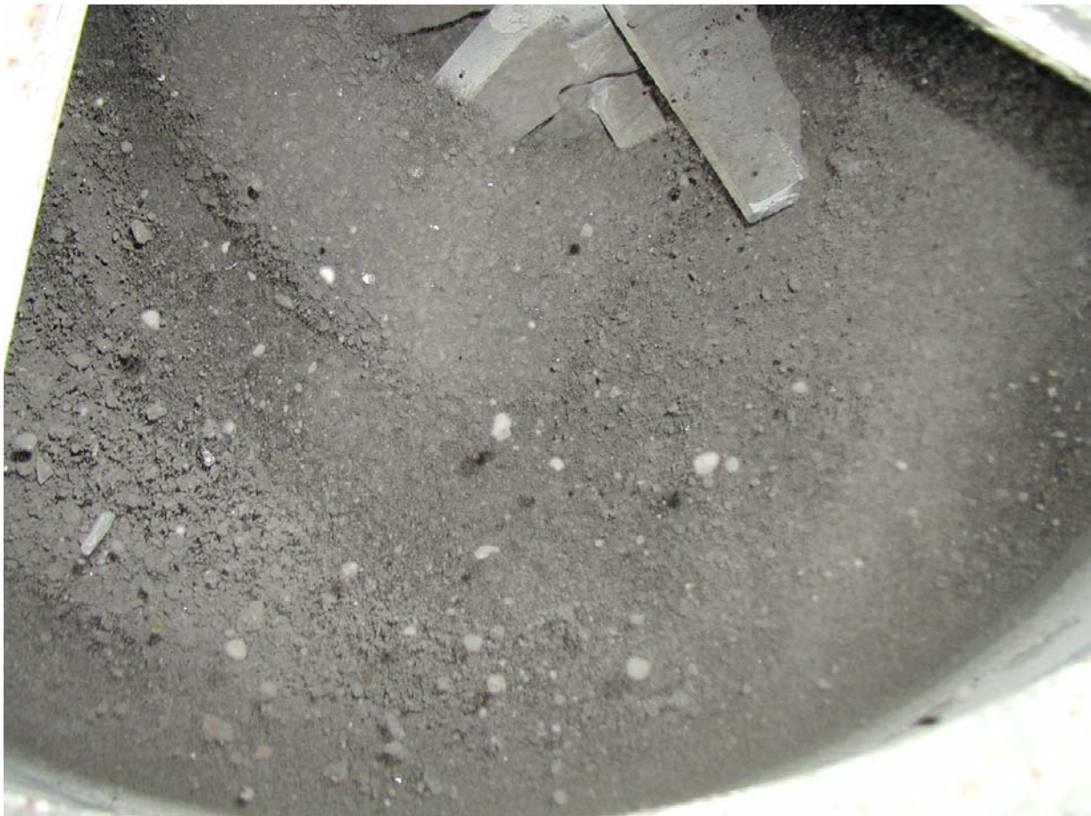
Abbildung 8: Homogenisierung der Hausmüllverbrennungsasche im Eirich-Intensivmischer
