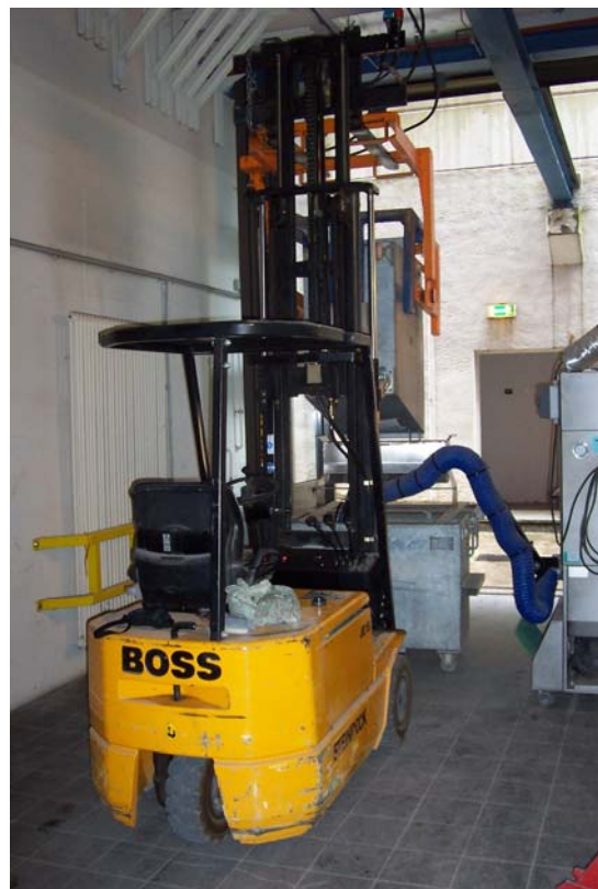
Abbildung 11: Entleeren eines Abwurfbehälters der VAUB über den Riffelteiler (Teilung)
