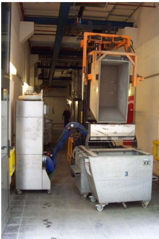
Abbildung 11: Entleeren eines Abwurfbehälters der VAUB über den Riffelteiler (Teilung)
