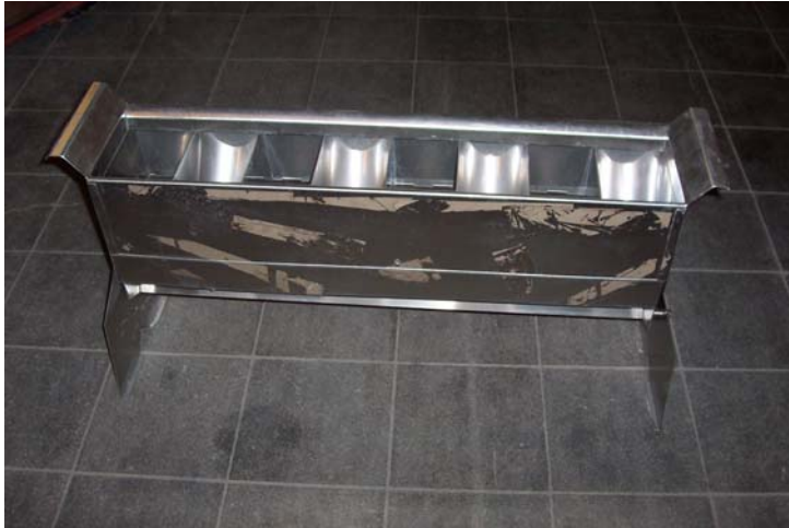
Abbildung 10: Riffelteiler für Materialien mit 32 mm Größtkorn (links) und Aufbau zur Teilung in die Abwurfbehälter (rechts)
