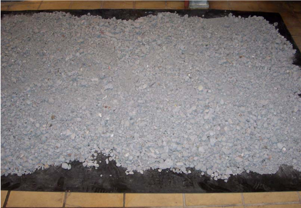
Abbildung 3: Trocknung Hausmüllverbrennungssasche (RM MV)
