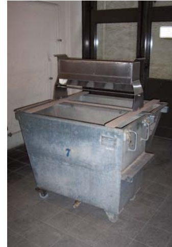
Abbildung 10: Riffelteiler für Materialien mit 32 mm Größtkorn (links) und Aufbau zur Teilung in die Abwurfbehälter (rechts)
