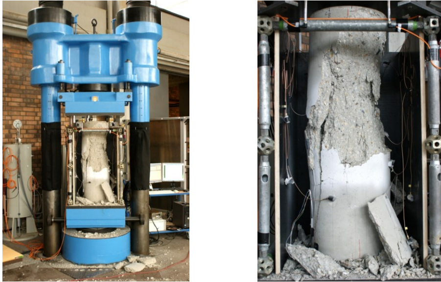
Abbildung 4.30: Fotos einer Großprobe in der Prüfmaschine nach dem Ermüdungsversagen
