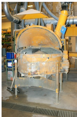
Abbildung 4.8: Zur Betonherstellung verwendeter 250l Mischer (links), 51 gefüllte Formen einer Mischung direkt nach der Betonierung (rechts)
