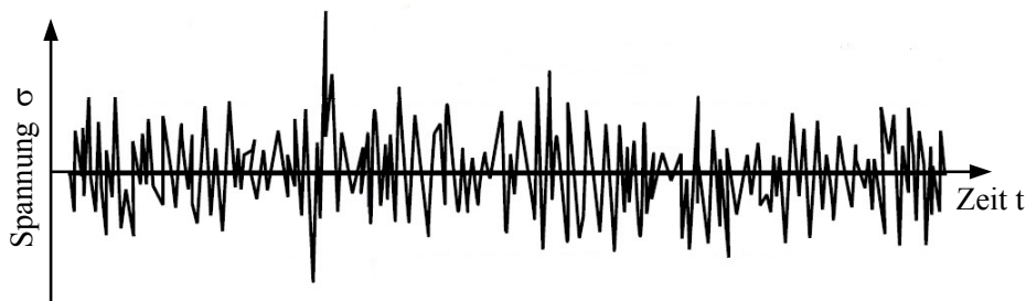
Abbildung 2.6: Beispielhafter Zeitverlauf einer regellosen variierenden Betriebsbeanspruchung
