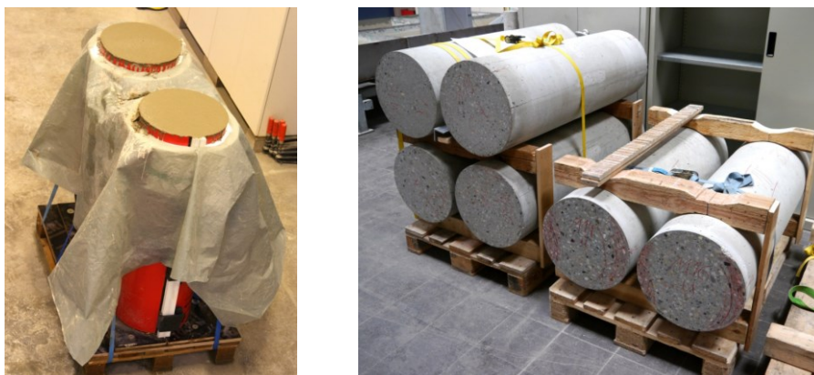
Abbildung 4.9: Zwei frisch betonierete große Zylinder in ihrer Form (links), Lagerung mehrerer großer Zylinder nach dem Schleifen auf Europaletten
