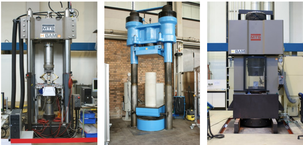
Abbildung 4.10: 1MN Prüfmaschine zur Prüfung der kleinen Zylinder (links), 10MN Prüfmaschine für die Prüfung der großen Zylinder (Mitte) und 5MN Prüfmaschine zur Prüfung der Würfel (rechts)
