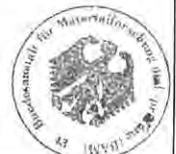
Eine Oberfläche ist mit einer Kennzeichnung nach Nr. 3.4 versehen. Die Kennzeichnung muss auf der sichtbaren Oberfläche der verlegten KDB gut erkennbar sein. Der Randbereich der Oberflächen der Dichtungsbahn, wo planmäßig das Schweißen erfolgt, wird durch Schutzstreifen vor Verschmutzung geschützt.
