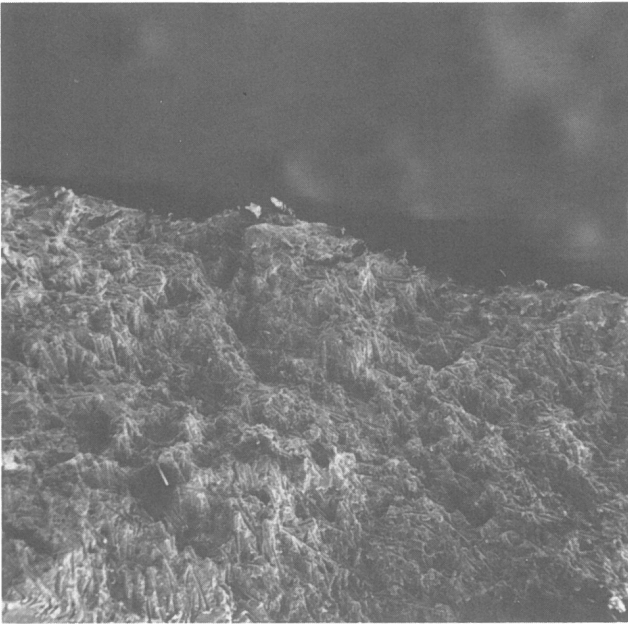
Bild : 50.1 Prot.Nr.: 115-6 Material: PA 6+25%GF Aufnahme-Nr.: 14629 N_B = 16,0 \cdot 10^6 \epsilon_{max} = 8,2 \text{ ‰} f = 16,7 \text{ Hz} E_{VB} = 3216 \text{ N/mm}^2 V = 50:1 \Delta N_{VB} = 84 \text{ 000} D-Bruchwurzel Bemerkung: Ausschn.:50.3 und 50.5
