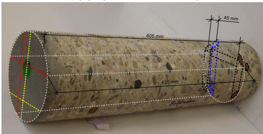
Bild 12 Bohrkern mit Markierung der hinteren Bewehrung. Rot gestrichelt: Auf der Oberfläche aufgezeichnete Lage der hinteren Bewehrung als Ergebnis der Ultraschallmessung; Schwarz gestrichelt: Tatsächlicher Verlauf der Bewehrung; Blau gestrichelt: In die Tiefe übertragene ermittelte Lage des abweichenden Stabes
