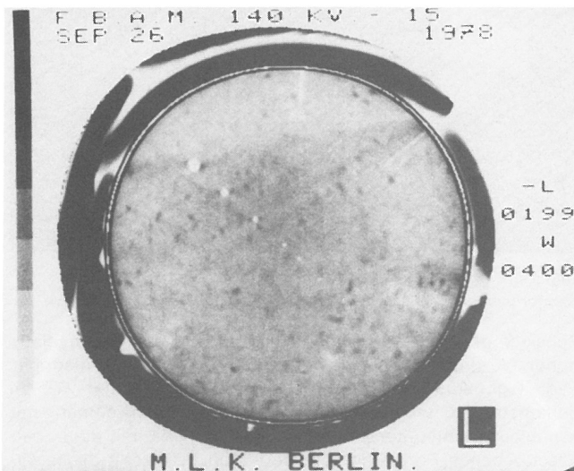
Abb. 3.10 Tomogramm einer Acetylenflasche mit Testfehlern: 2 Schlitze (1 mm und 2 mm breit) 7 Bohrungen (kleinster Durchmesser 1 mm)
