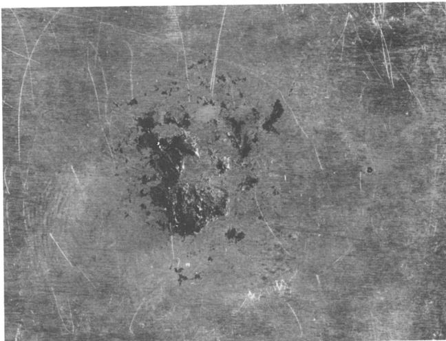
Abb. 6.12 a Stahl mit Schlackeneinschluß
