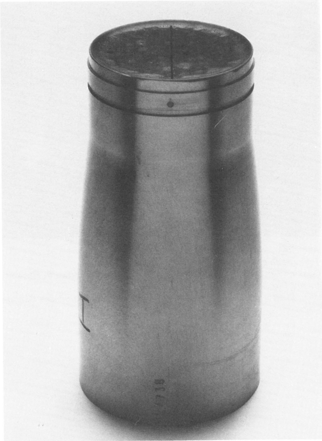
Abb. 6.2 a Modell einer Sprengkapsel; Sprengstoff durch Araldit nachgebildet; äußerer Mantel: Cu-Sn Legierung; Testfehler (Bohrungen), Breite des Risses = 0,5 mm
