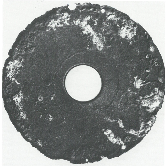
Abb. 37 Fortgeschrittener Korrosionsangriff der Scheibenelektrode, V = 3,5 : 1
