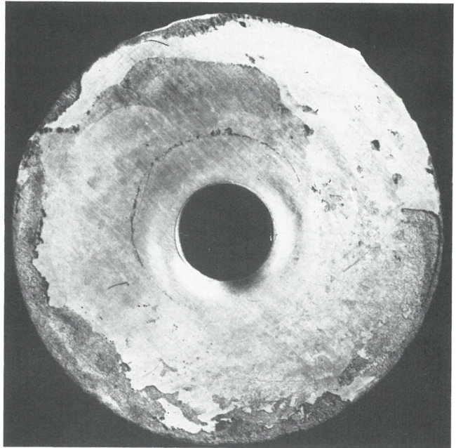
Abb. 36 Spaltkorrosionselektrode mit Korrosionsangriffen, V = 3,5 : 1
