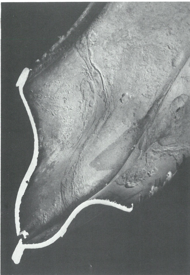
Abb. 5 Elementkorrosion in den Sicken von Stahlradiatoren mit Leckage
