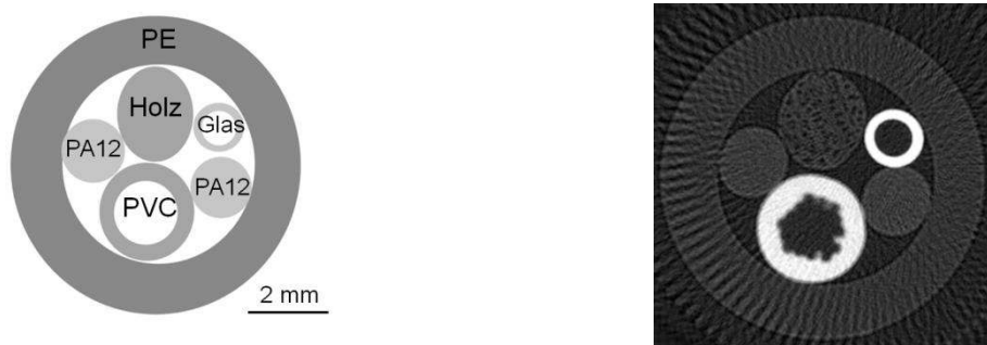
Abb. 7: Skizze der Multimaterialprobe, einem Polyethylenrohr gefüllt mit unterschiedlich starken Absorbern (links) und die zugehörige CT-Rekonstruktion (Gefilterte Rückprojektion) des Transmissionssignals.
