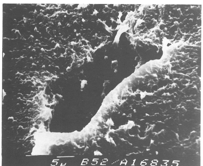
Bild 47 Ausschnittvergrößerung von Bild 46 mit dem Ausbruch im Bruchanfang. Vergrößerung: 2200 : 1
