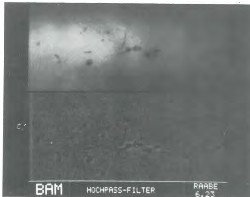
Bild 6.1.6.1-7A: Schweißnahtaufnahme mit eingelagerten Poren, Hochpaßfilterung zur Unterdrückung störender Schweißnahtstrukturen
