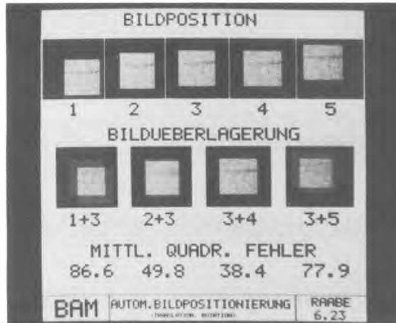
Bild 3.1.7-3: Darstellung der schrittweisen Bildpositionierung bei gleichzeitiger Berechnung der quadratischen Fehler der Differenzbilder.
