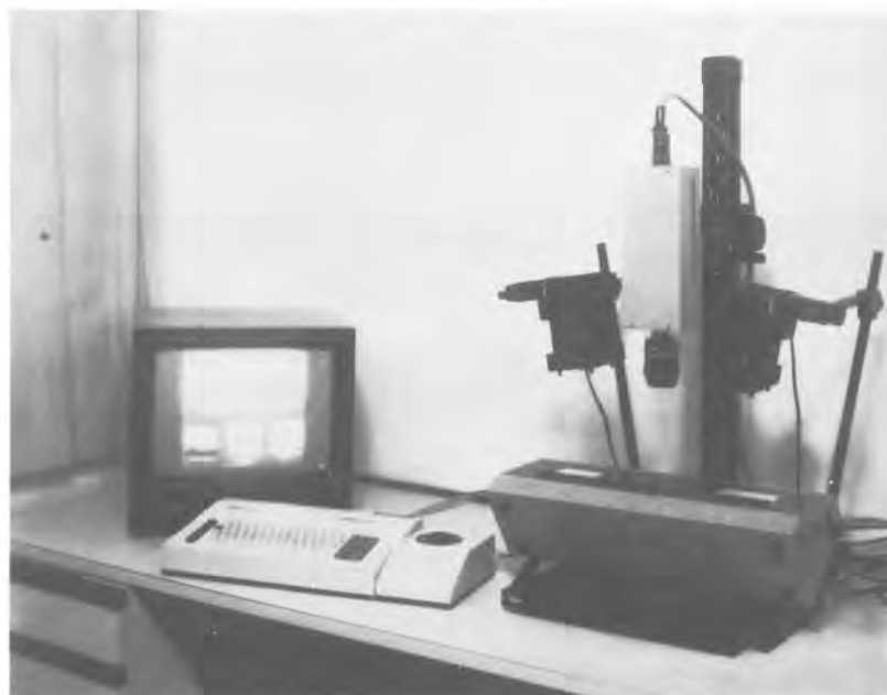
Bild 4.1.1-2: Bildeinzugsystem mit Videokamera, Kamerastativ, Filmbetrachtungsgerät und Kontroll-Monitor
