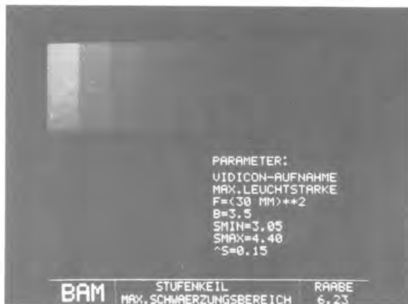
Bild 4.1.3.3-2: Stufenkeil ( F = 30 \times 30 mm) mit Schwärzungsbereich von S_{\min} = 3,05 bis S_{\max} = 4,40 .
