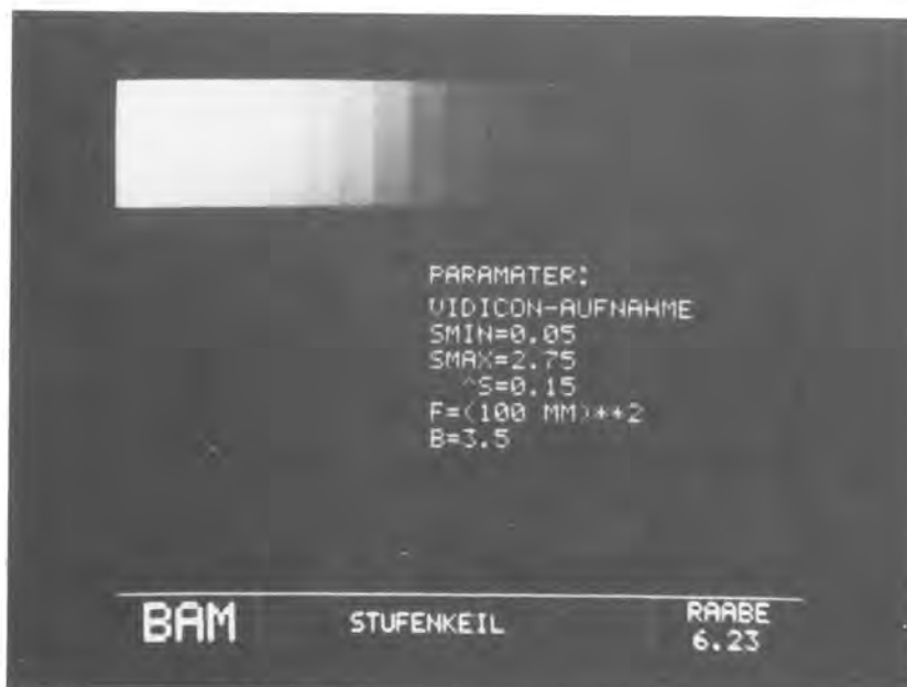
Bild 4.1.3.3-1: Stufenkeil (AGFA), 25 \times 125\text{ mm} , S_{\min} = 0,04 , S_{\max} = 2,7
