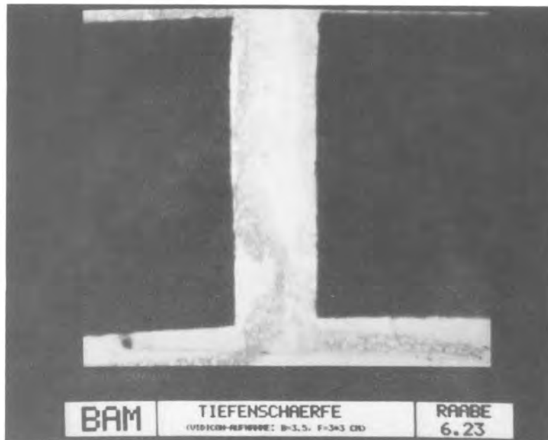
Bild 4.1.3.3-8: Bildaufnahme zur Tiefenschärfebestimmung mit Blendenzahl B = 3,5 .
