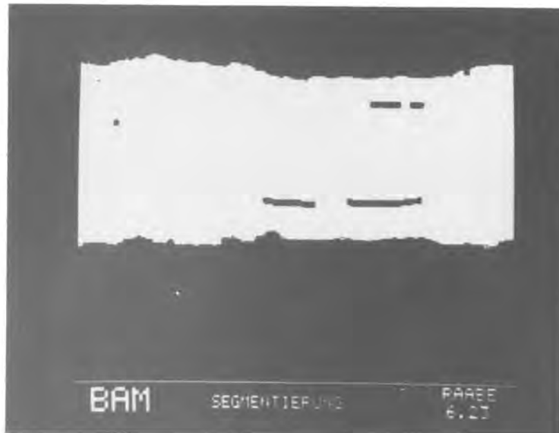
Bild 6.1.6.1-8C: Unterdrückung von Störstrukturen durch Einsatz einer Median-Filterung und abschließender Tiefpaßfilterung
