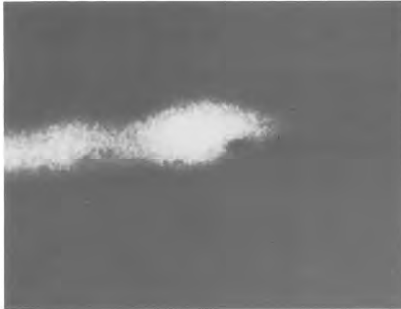
Bild 6.1.6.1-1: Typische Schweißnahtaufnahme mit hellem Schweißnahtbereich und eingelagerten Fehlern, sowie angrenzendes Muttermaterial (dunkler Bildbereich)
