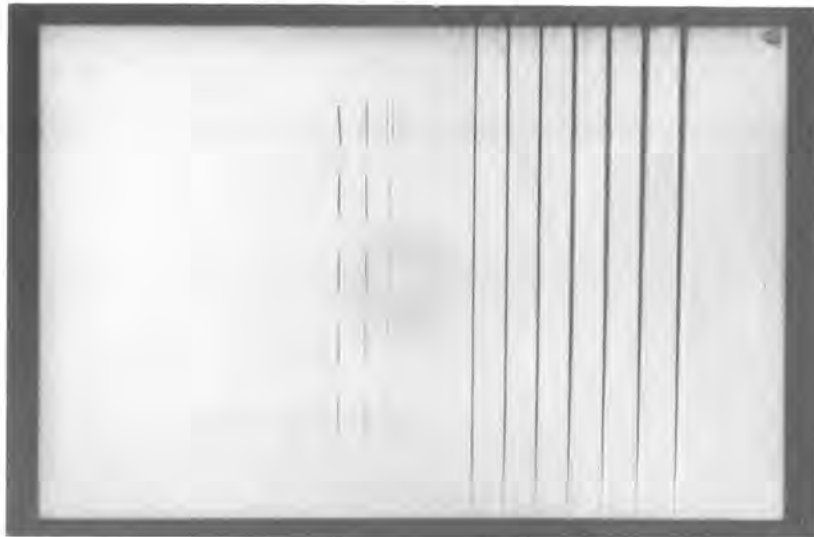
Bild 6.1.4.2-6: Testplatte mit künstlichen Fehlern
