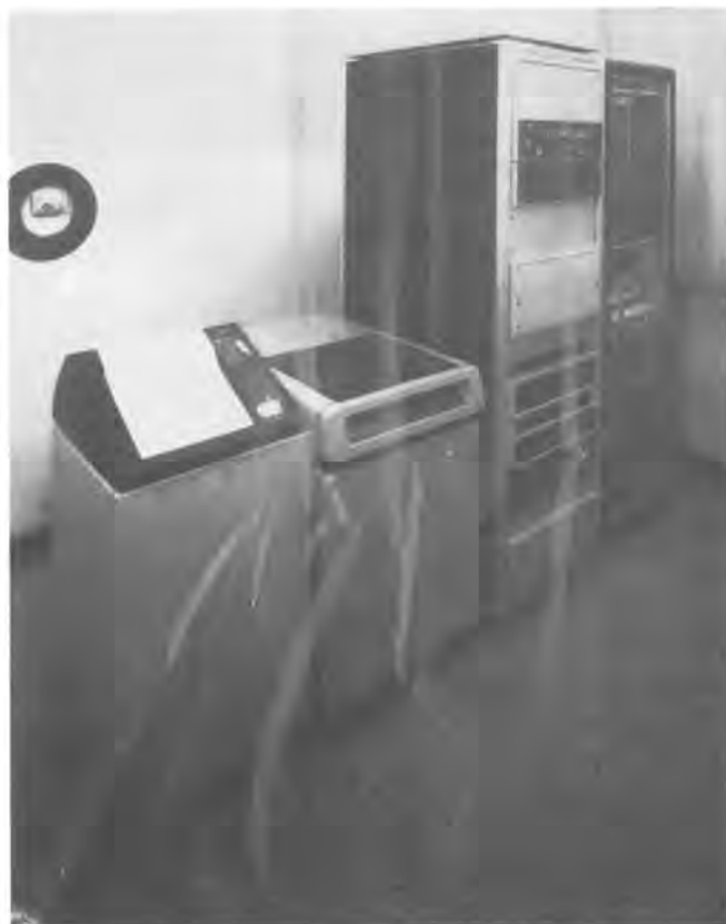
Bild 4.1.2-2: Rechenanlage mit Prozeßrechner, Bildverarbeitungssystem, Plattenturm-Laufwerk und Bandmaschine
