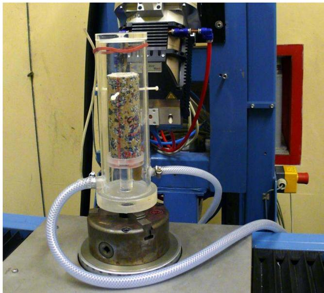
Abb. 8: Prüfkörper in Befeuchtungseinrichtung auf Manipulatorisch
