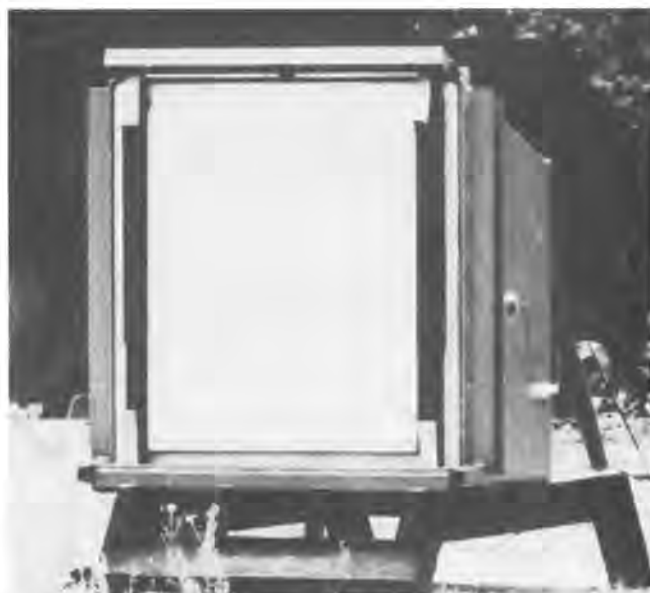
Bild 2 1-m 3 -Stahlkasten mit 10-%-Öffnung und Spanplatte
