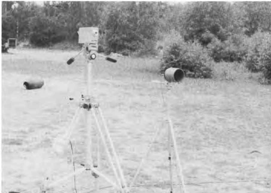
Abbildung 1a Links pyroelektrischer Empfänger (KT 79, Firma Heimann), rechts thermoelektrischer Empfänger (BAM 4.33)
