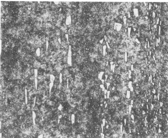
c) gehärtet und bei 250 °C angelassen Härte: 750 HV10
