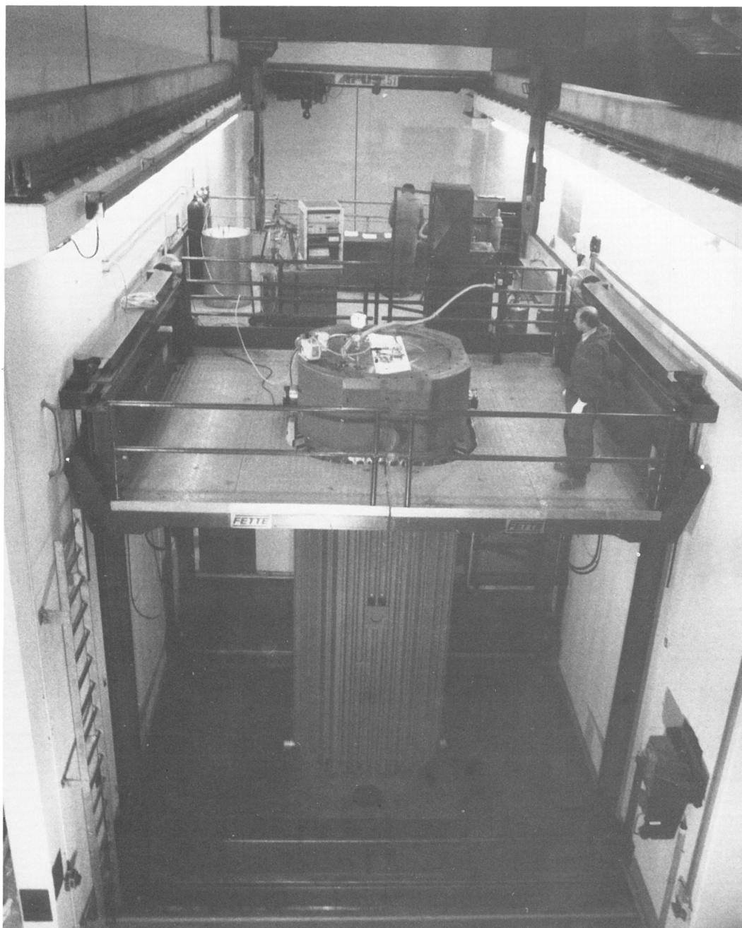
Abb. 6 Behälter-Annahmestation des Brennelement-Zwischenlagers Gorleben (mit freundlicher Genehmigung der Brennelementlager Gorleben GmbH)
