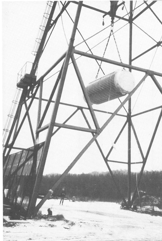
Bild 7 Fallversuch mit dem Prototyp eines Brennelement-Transportbehälters aus Sphäroguss
