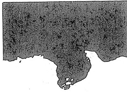
Bild 10: (M 4017) Lochkorrosion im Abhänger im Querschliff v = 100 : 1
