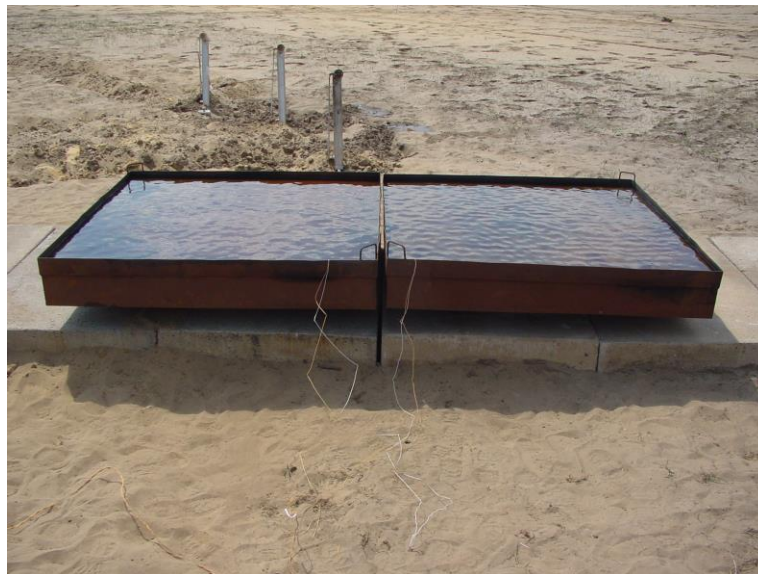
Abb. 2: Aufbau der Abbrandwannen ( d = 1.5 \text{ m} ) mit D/d = 0 für die Durchführung der Feldversuche.
