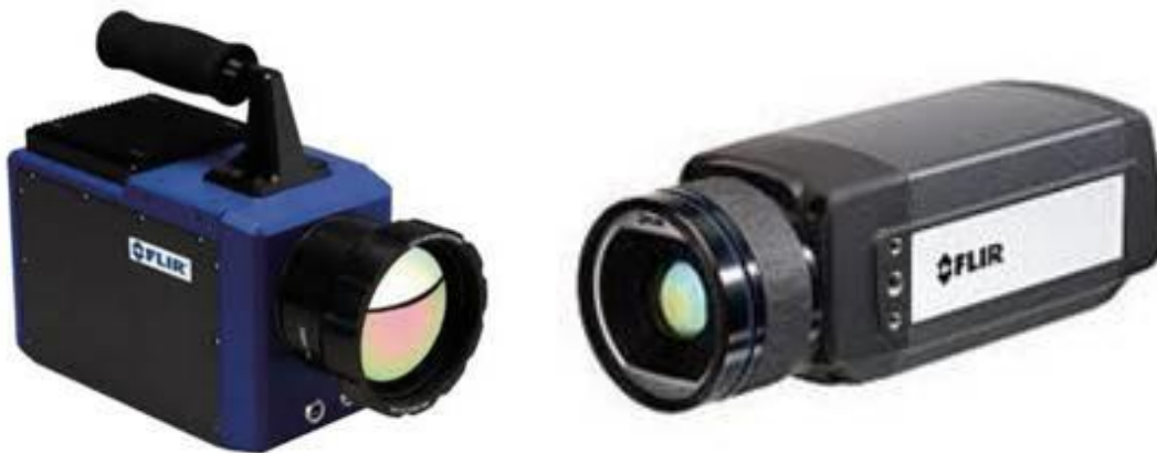
Abb. 4: IR-Kamera Systeme FLIR SC700 (gekühlter InSb-Detektor MIR 3–5 \mu\text{m} ) und FLIR SC655 (ungekühltes Mikrobolometer FIR 7.5–15 \mu\text{m} ) zur Messung der Flamm-oberflächentemperaturen.
