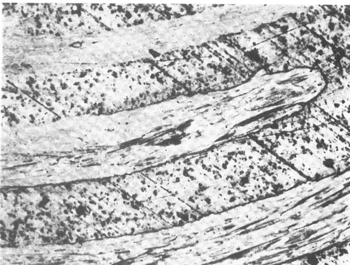
Bild 40 Festkörperreibung von TiO_2 gegen sich selbst (Versuchsdauer 30 min, Temperatur 400^\circ C , Gleitgeschwindigkeit 26,2 cm/s, Pressung 2,54 bar) /101/.
