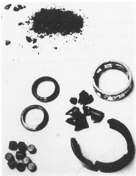
Bild 16 Katastrophales Versagen eines vollkeramischen Kugellagers /52/.
