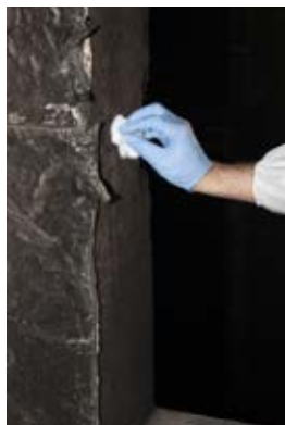
Abbildung 42: Entnahme einer Wischprobe mit Glaswolle nach dem gelöschten Brand.
