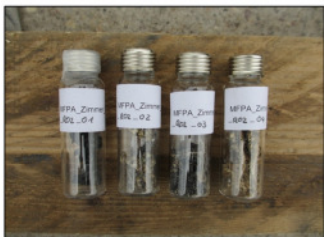
Abbildung 41: Probenahme einer Brandrückstandsprobe nach gelöschtem Brand.
