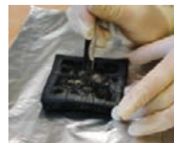
Abb. 7: Entnahme einer Brandrückstandsprobe für die SPME-Analyse
