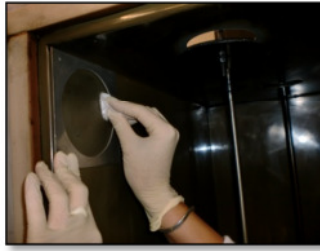
Abbildung 25: Wischproben von den Wänden der Rauchkammer.
