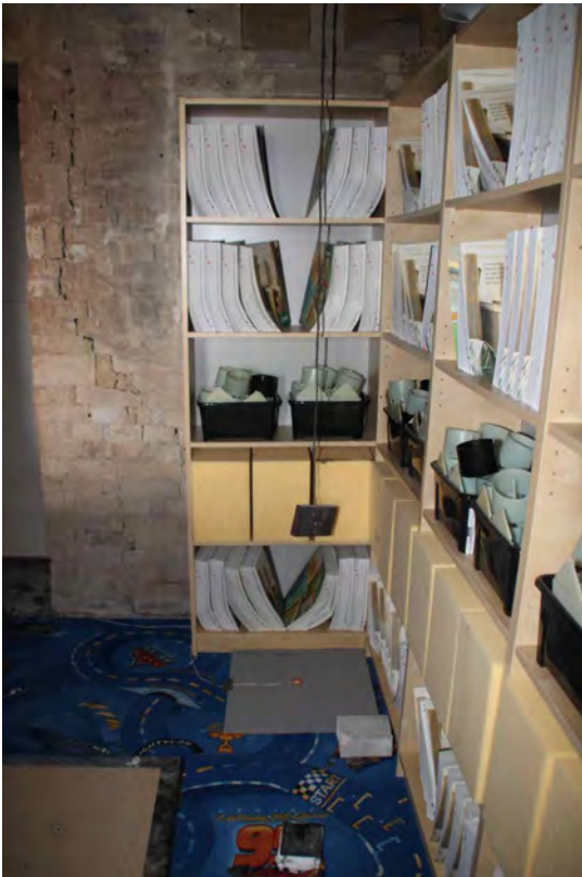
Abbildung C.30: Regalecke im Brandraum mit dem Teppichelement
