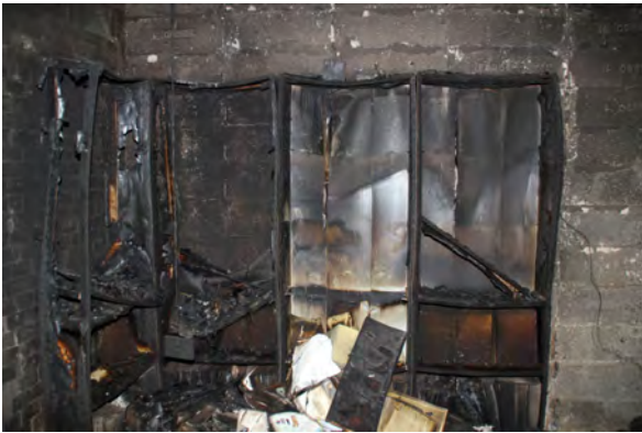
Abbildung C.67: MFPA_Zimmer_005: Regalecke nach dem Versuch
