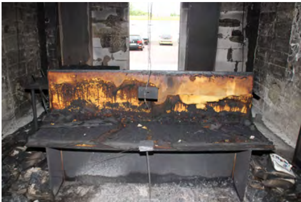
Abbildung C.59: Brandrückstand Sofa nach Versuch MFPA_Zimmer_005
