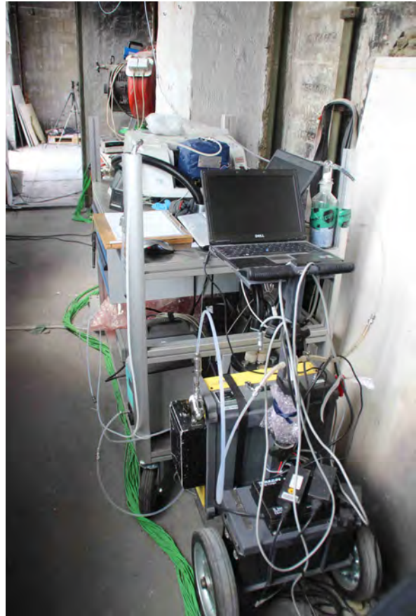
Abbildung C.43: FTIR-Spektrometer G1 (hinten) und G5 (vorne) im Nebengang
