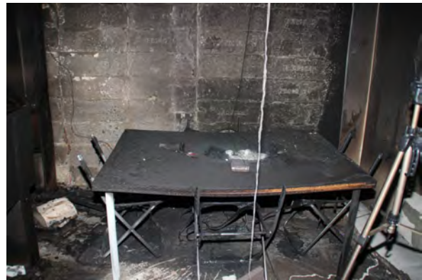
Abbildung C.60: Brandrückstand Esstisch nach Versuch MFPA_Zimmer_005
