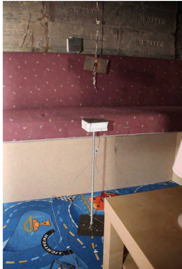
Abbildung C.49: Plattenthermometer T14 (vorne auf Ständer) und T15 (hinten an Lehne) an Sofa 1. In der Mitte befindet sich die vertikale Temperaturmessstelle T6.
