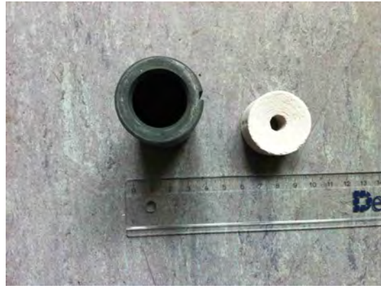
(b) Einsatz (links) und Isolierung (rechts)
