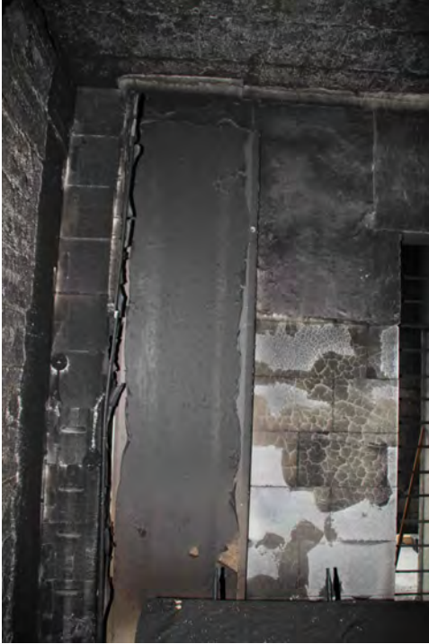
Abbildung C.61: MFPA_-Zimmer_005: Tapetenelement 1 nach dem Versuch
