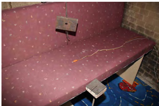
Abbildung C.35: Zünder auf Sofa 1, Brandbeschleuniger wurde noch nicht appliziert
