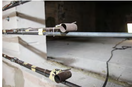
(b) Einzelne Sonden und Mantelthermoelemente
