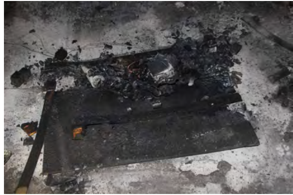
Abbildung C.66: MFPA_Zimmer_005: Brandrückstand Couchtisch
