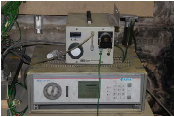
Abbildung C.46: Analysator G2 mit Messgasaufbereitung (oben)
