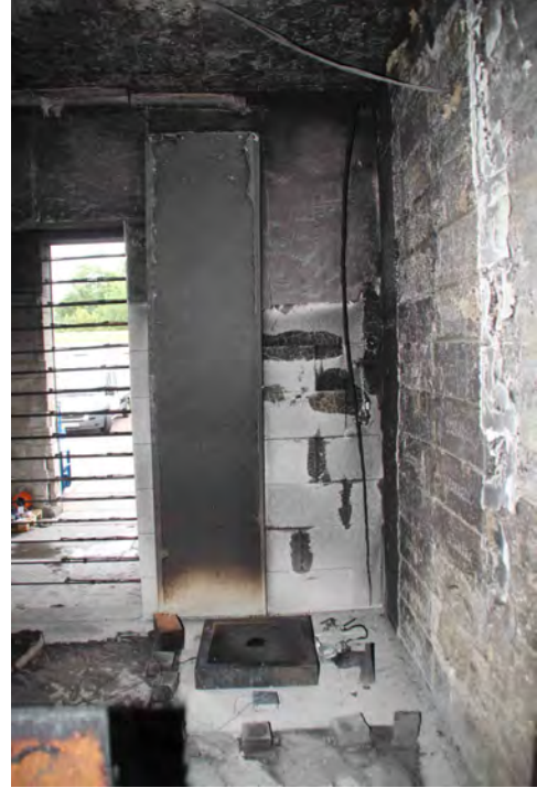
Abbildung C.62: MFPA_-Zimmer_005: Tapetenelement 2 und Referenzecke nach dem Versuch
