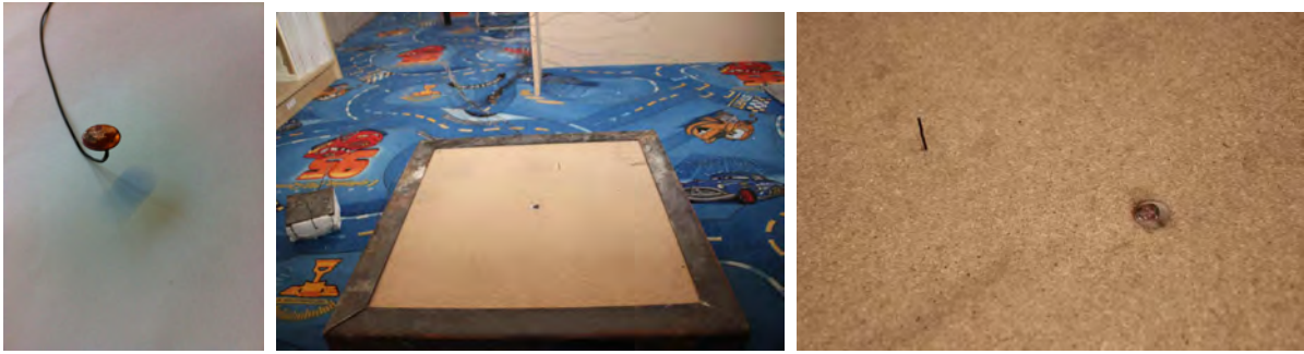
(a) Einzelansicht (b) Einbauzustand in der Spanplatte (c) Einbauzustand, Nahaufnahme mit Thermoelement zur Messung der Fluidtemperatur
