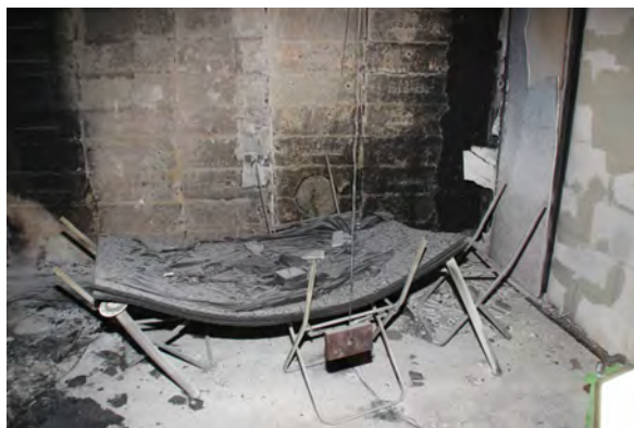
Abbildung C.56: MFPA_Zimmer_002: Brandschutt Esstisch, Blick aus der Referenzecke, Aufnahme am Morgen nach dem Versuch. Die Tischplatte ist zum Großteil noch erhalten.
