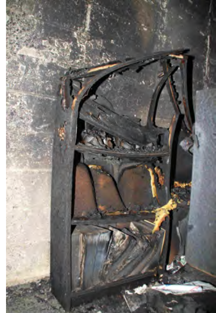
Abbildung C.64: MFPA_-Zimmer_005: Brandrückstand Regal 1
