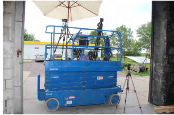
Abbildung C.39: Podest für Kameras K3 und K4 im Tor des Versuchsgebäudes
