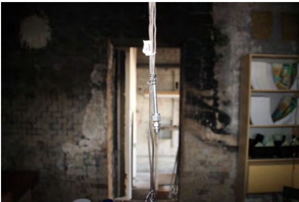
Abbildung C.40: Messstelle G1, Ende der Zuleitung im Brandraum an der vertikalen Temperaturmessstelle T5
