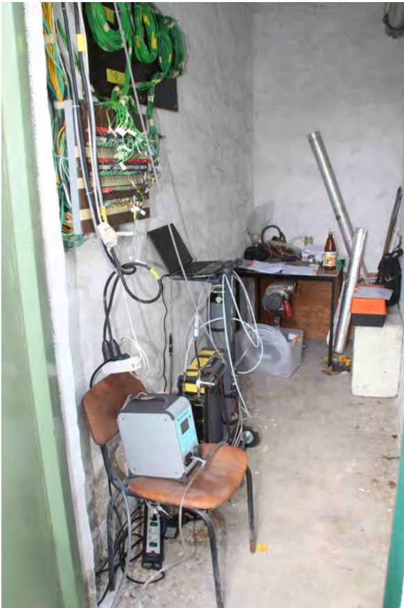
Abbildung C.48: Analysatoren G4, Sauerstoffanalysator (vorne) und FTIR-Spektrometer (hinten)
