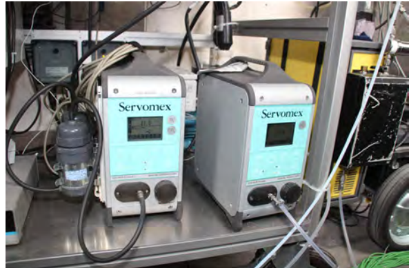
Abbildung C.45: Sauerstoffanalysatoren G1 (links) und G5 (rechts) im Nebengang
