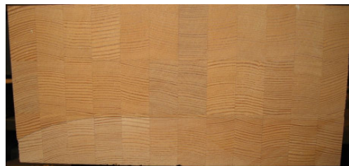
Bild 2 Aus 3 x 12 Holzquadern geleimter Probekörper mit weitgehend homogener anisotroper Struktur (hier: Buchenholz).
