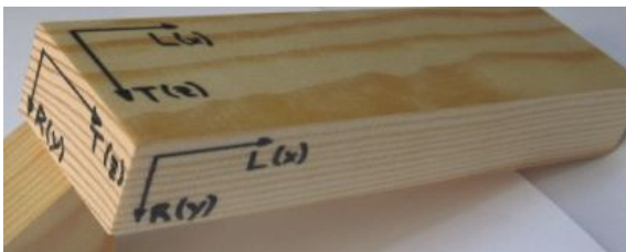
Bild 1 Symmetrieachsen in orthotropem Holz Longitudinal L (Faserrichtung), Radial R , Tangential T .
